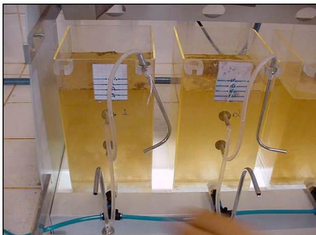
Figura 4.8 – Introdução de água saturada com ar: Flotação
