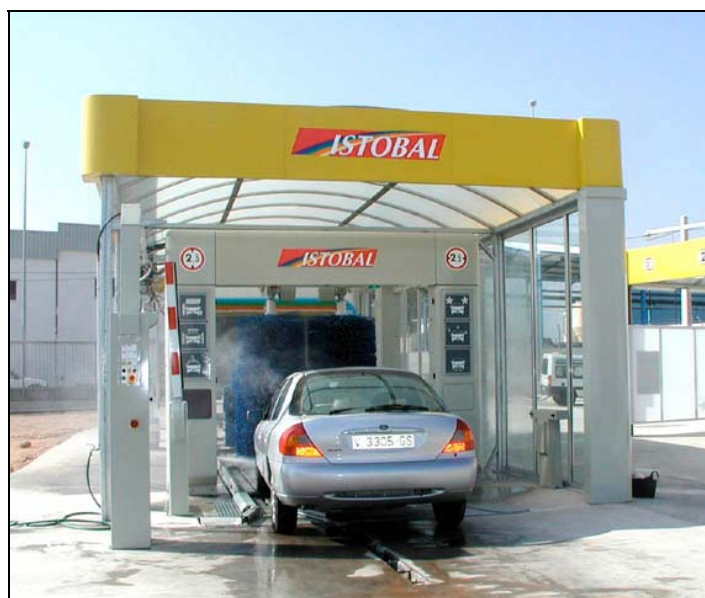
Figura 3.5 – Lavagem de carro do tipo “Túnel”, com a sujeira sendo mecanicamente removida por escovas
