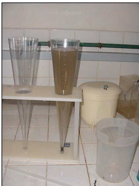
Figura 4.12 – Ensaio de sólidos sedimentáveis no cone de Inhoff
