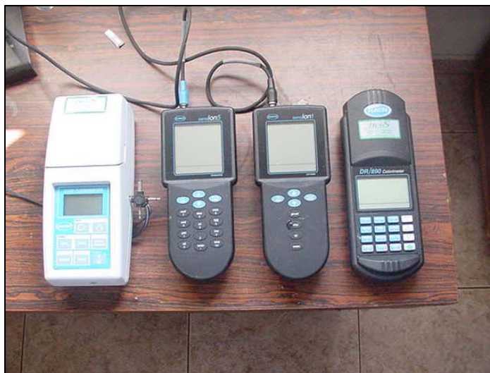
Figura 4.2 – Turbidímetro, condutivímetro, pHmetro e colorímetro
