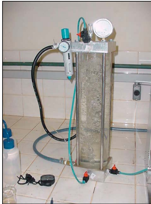
Figura 4.5 – Câmara de pressurização e recirculação
