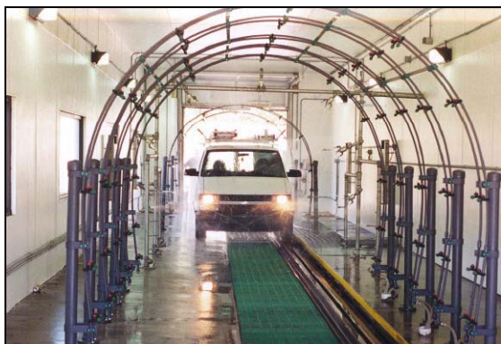
Figura 3.6 – Lavagem de carro do tipo “Túnel” com sujeira sendo mecanicamente removida por jatos de alta pressão
