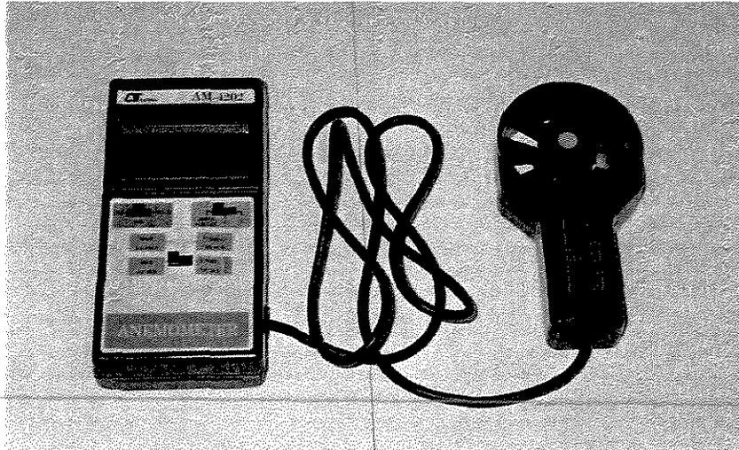
FIGURA 12 – Termoanemômetro com sensor de hélice.
