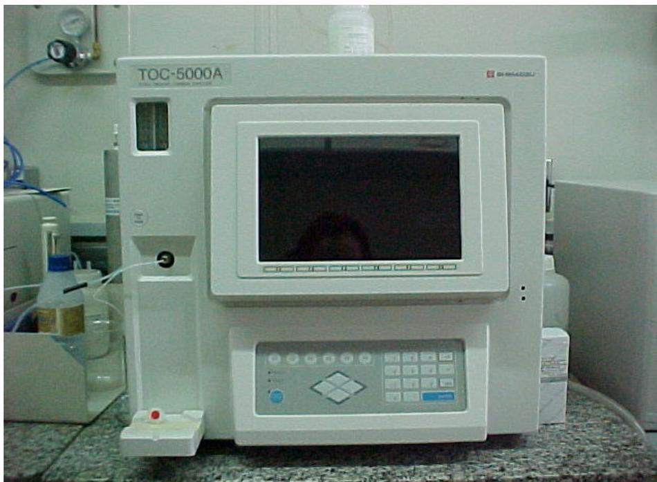
**Figura 4.5** - Aparelho TOC Modelo TOC – 5000A SHIMADZU
