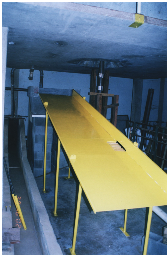
Figura 6.2. Banco de ensaio com o reservatório de estabilização a montante.
