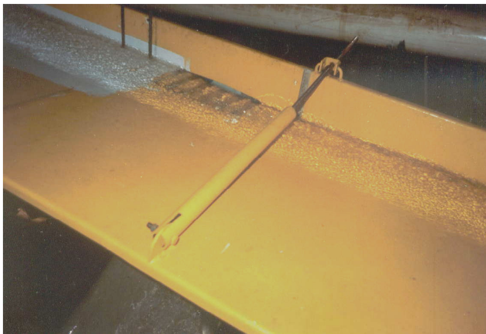
Figura 6.7. Captação do escoamento pela boca-de-lobo com defletores. (modelo 1:3)
