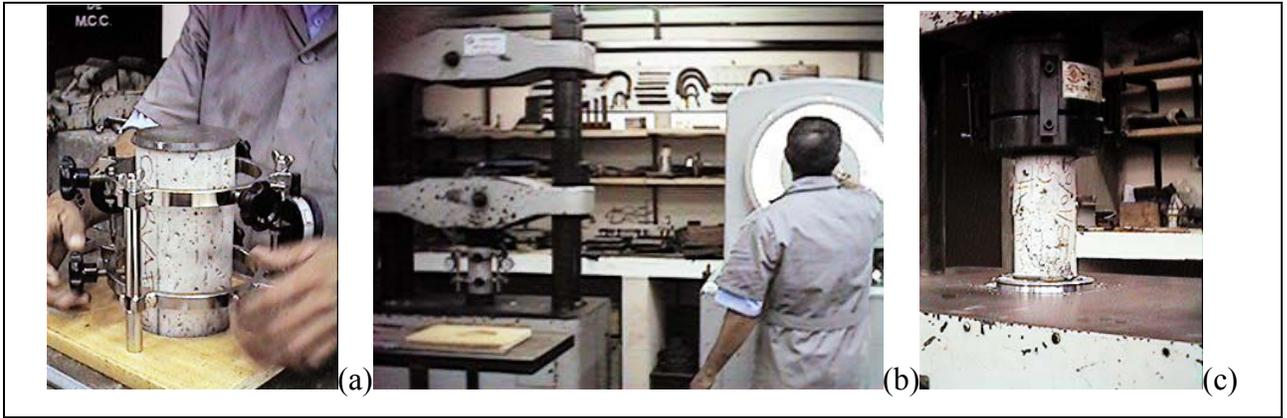
Figura D.16 - Determinação do módulo estático de elasticidade e deformação
