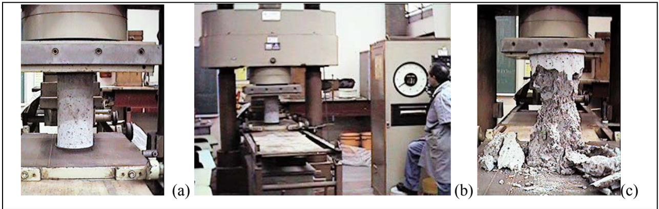
Figura D.13 - Determinação da resistência à compressão de corpos-de-prova cilíndricos
