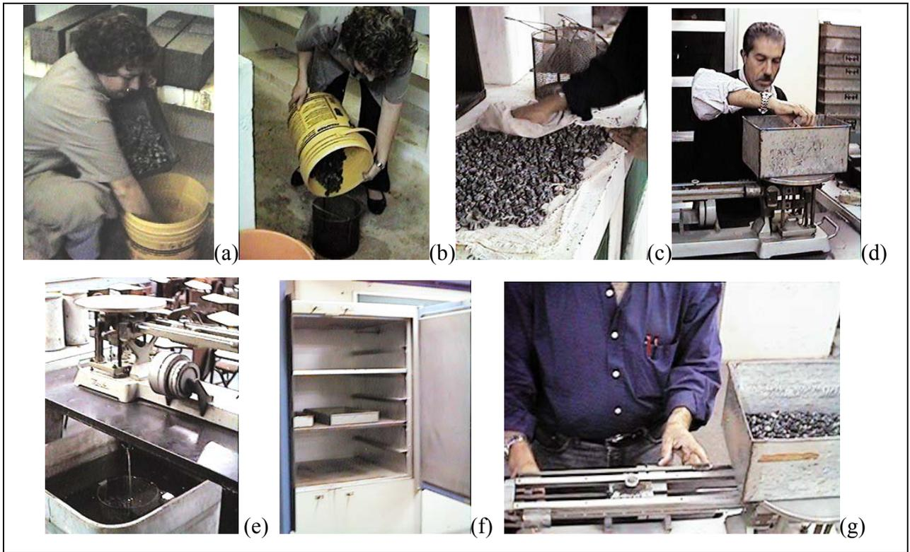
Figura D.9 – Determinação da massa específica do agregado graúdo
