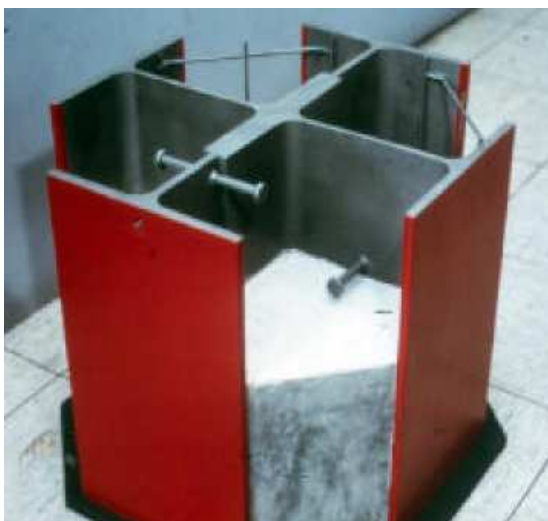
Figura 2.6 – Pilar cruciforme parcialmente revestido com concreto.
