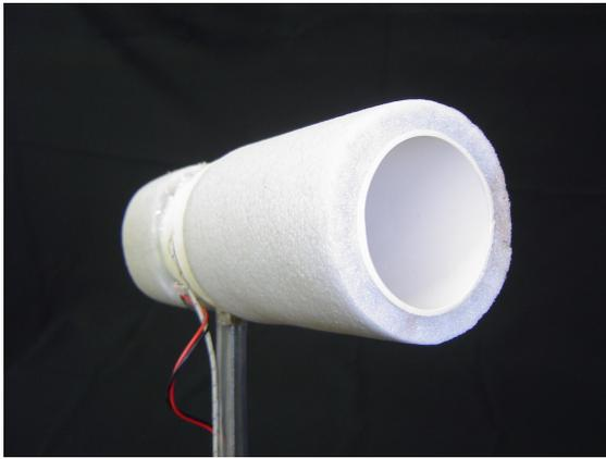
**Figura 4.11:** Tubo de PVC com revestimento
