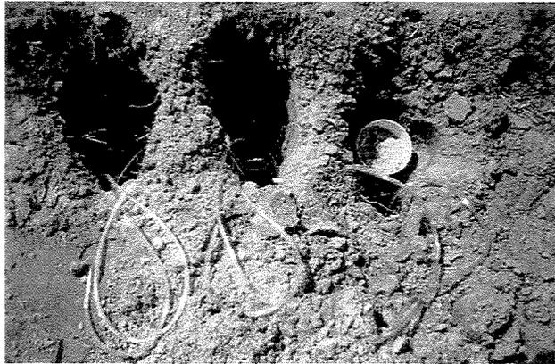
Figura 4.17 – Aspecto do posicionamento dos coletores de drenagem livre instalados nas profundidades de 25cm, 50cm e 75cm
