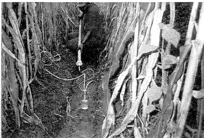
Figura 4.19 – Utilização do dispositivo desenvolvido para a extração de amostras no campo
