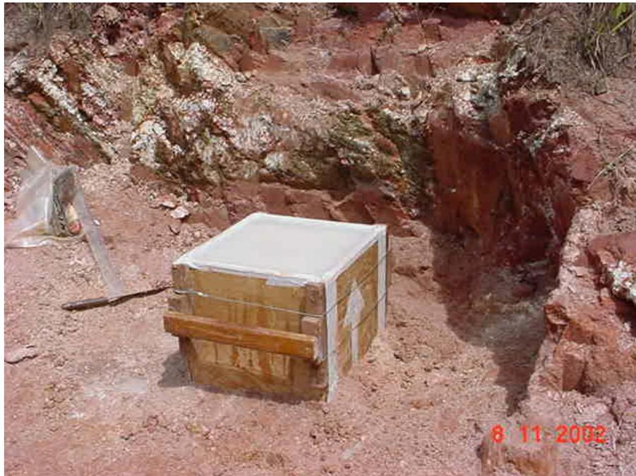
Foto 5.7 – Detalhe do perfil do solo referente à amostra 2. Notar lentes de material quartzo-feldspático de cor esbranquiçada.
