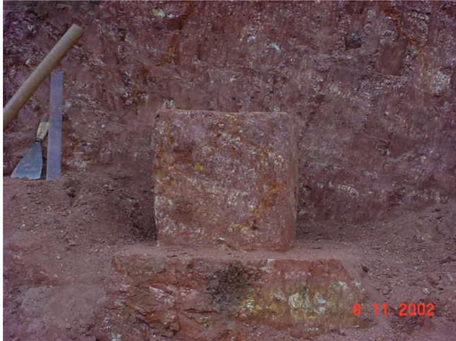
Foto 5.6 – Detalhe do perfil do solo referente à amostra 1. Notar que o solo encontra-se relativamente homogêneo.
