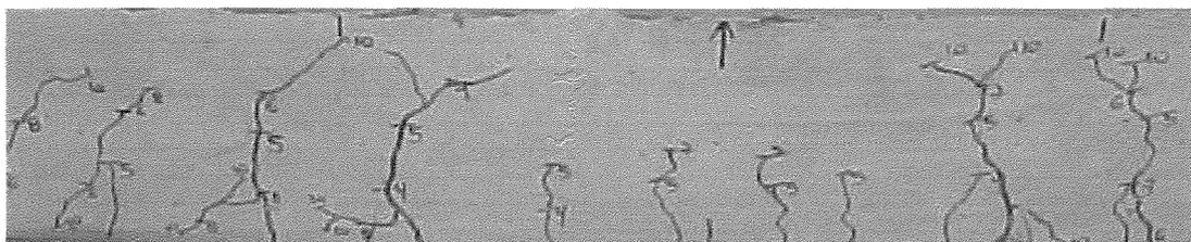
Figura 6.12 – Vista lateral do desenvolvimento das fissuras da viga 9 – CAT45
