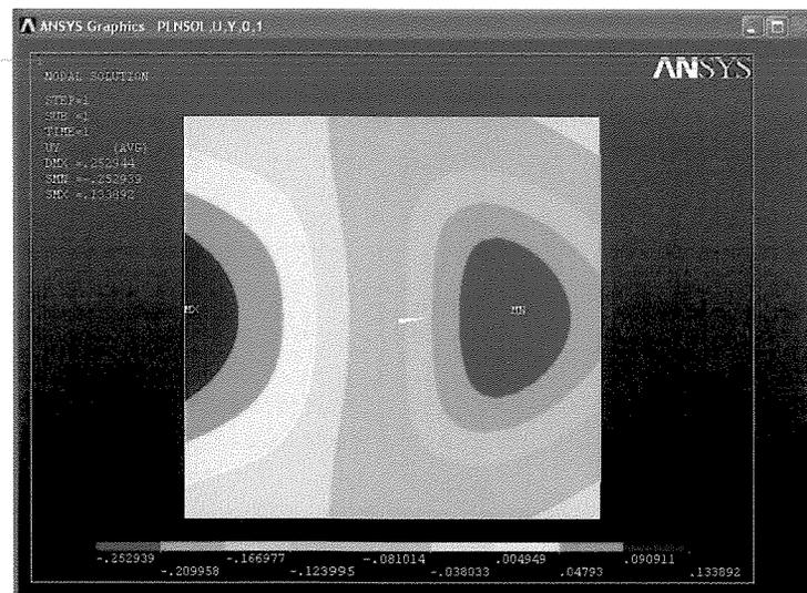
Figura 3.14 – Novos deslocamentos ( $\Delta_{Y_{\text{máx}}}=0,1339\text{mm}$ ;  $\Delta_{Y_{\text{mín}}}=-0,2529\text{mm}$ )
