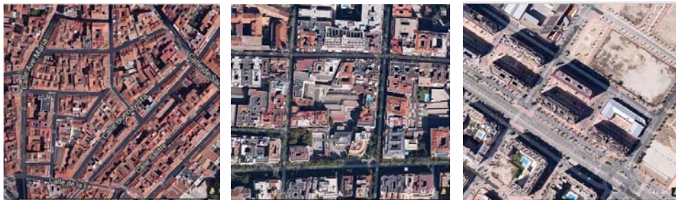
Figura 23: Comparação entre as densidades nos distintos traçados urbanos de Madri. Da esquerda para direita: Bairro Lavapiés (Casco histórico), Bairro Almagro (Ensanche de Castro, Sec. XIX), Bairro Vallecas (intervenções século XXI)
