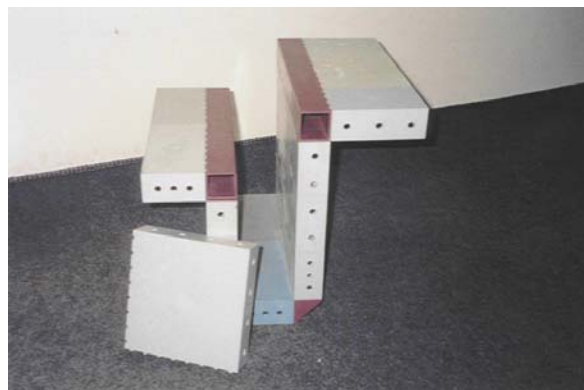
Figura 2.3.5.4 - Detalhe da composição das placas formando painel de viga (Madenor). Fonte: Mauro Satoshi Morikawa.
