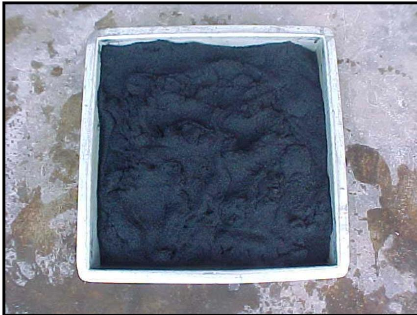
Figura 3.2.1.1 – Pó de borracha após a secagem
