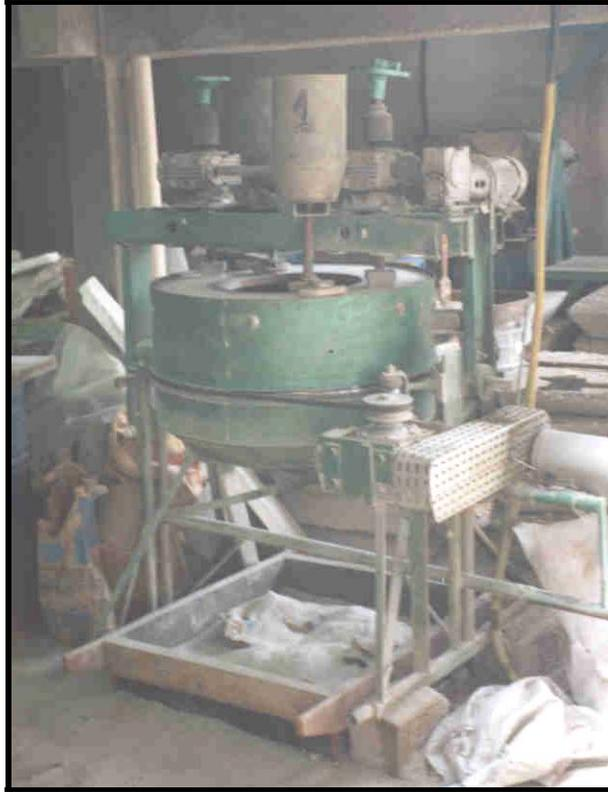
Figura 3.11.1 – Equipamento utilizado no ensaio de abrasão
