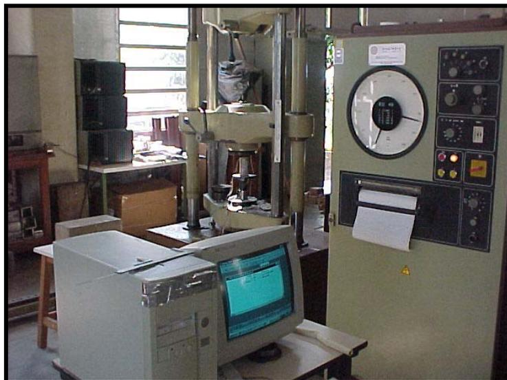
Figura 3.7.2 – Prensa hidráulica Dinateste
