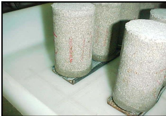
Figura 3.9.2 – Corpos de prova durante o ensaio de absorção
