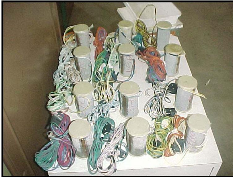
Figura 3.10.2 – Corpos de prova soldados aos cabos elétricos
