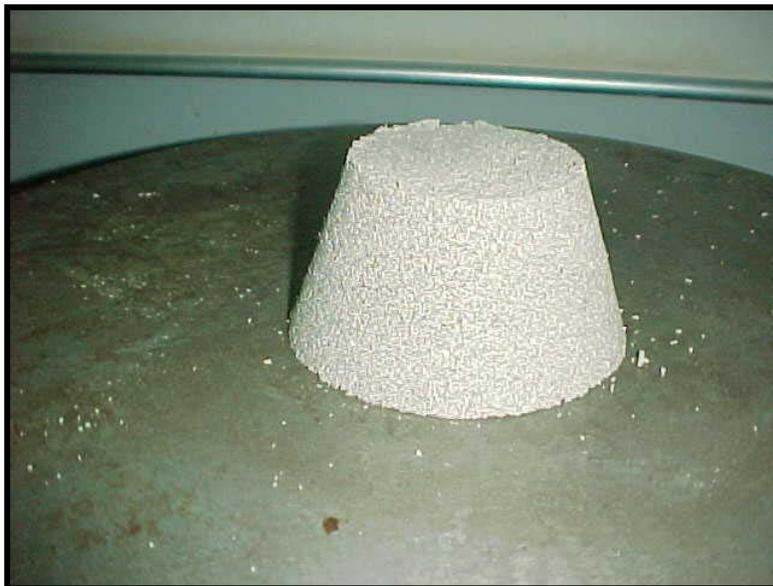
Figura 3.6.1.1 – Argamassa após a retirada do cone
