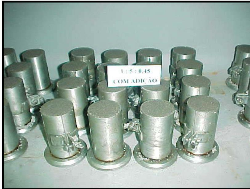
Figura 3.7.1 – Moldagem dos corpos de prova
