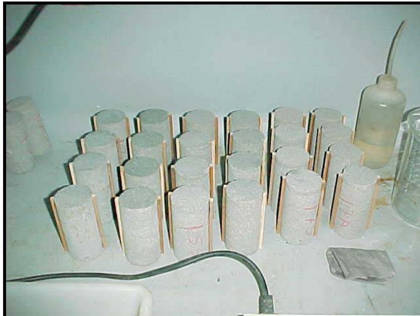
Figura 3.8.1 – Corpos de prova preparados para ensaio de compressão diametral
