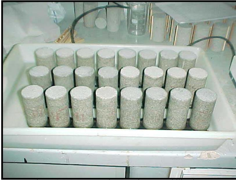
Figura 3.9.1 – corpos de prova impermeabilizados
