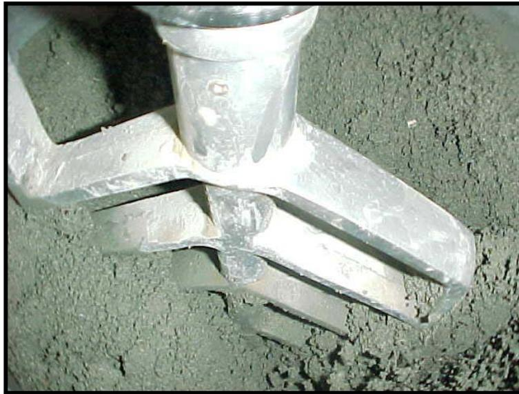
Figura 3.6.2 – Material seco da argamassa sendo misturado na argamassadeira
