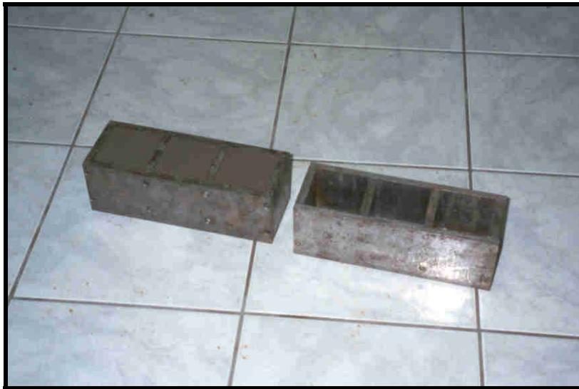
Figura 3.11.3 – Formas dos corpos-de-prova realizados no ensaio de abrasão
