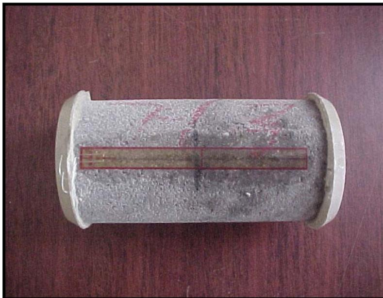
Figura 3.10.1 – Extensômetro colado do corpo de prova
