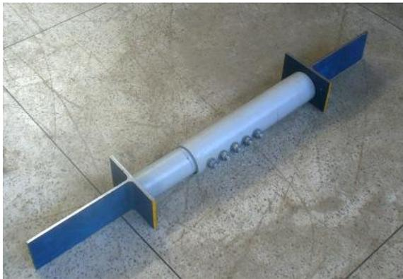
(a) Protótipo com perfil T nas extremidades
