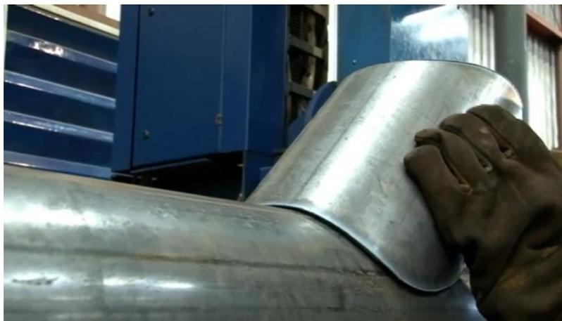
Figura 1.5 - Corte tipo boca de lobo. Fonte: Grupo Açotubo
