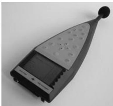
Figura 27: Medidor de Nível de Pressão Sonora utilizado - Brüel & Kjær mod. 2260
