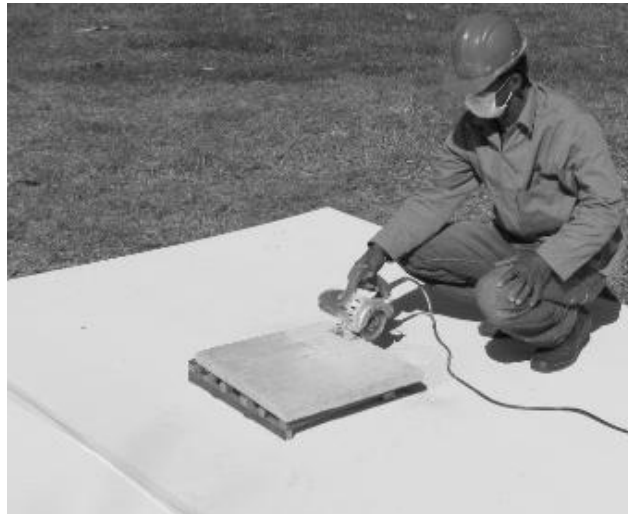
Figura 29: Disposição ilustrativa das condições de medição em campo livre sobre um plano refletor.
