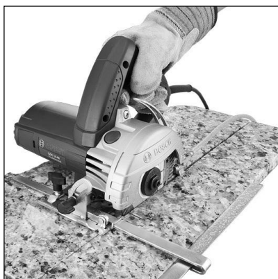
Figura 3: Serra-mármore operando em corte reto (a) e ilustrando sua versatilidade (b).
