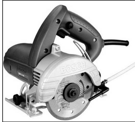
Figura 20: Modelo ilustrativo da serra-mármore utilizada nas operações
