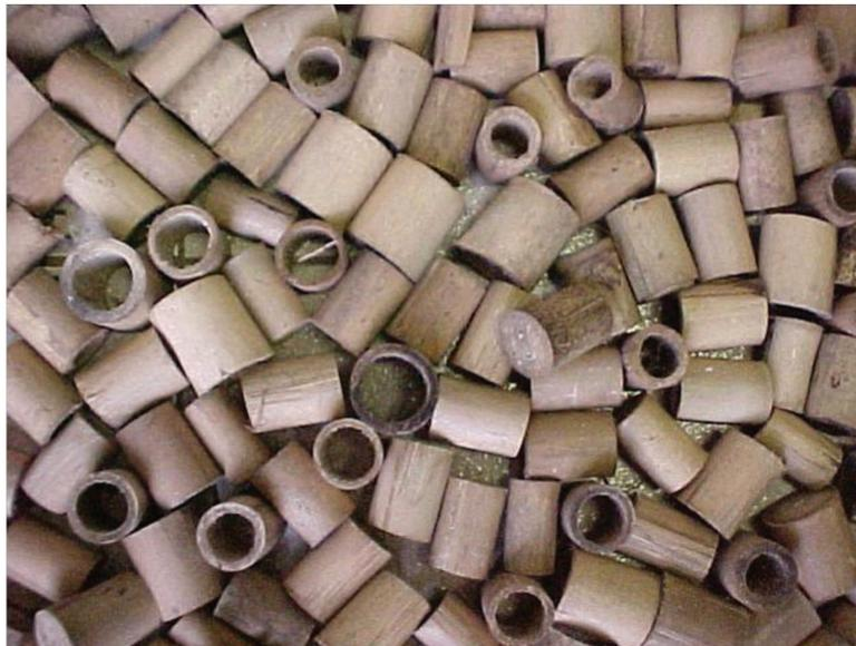
Figura 4: Anéis de bambu utilizados como material suporte do filtro anaeróbio.
