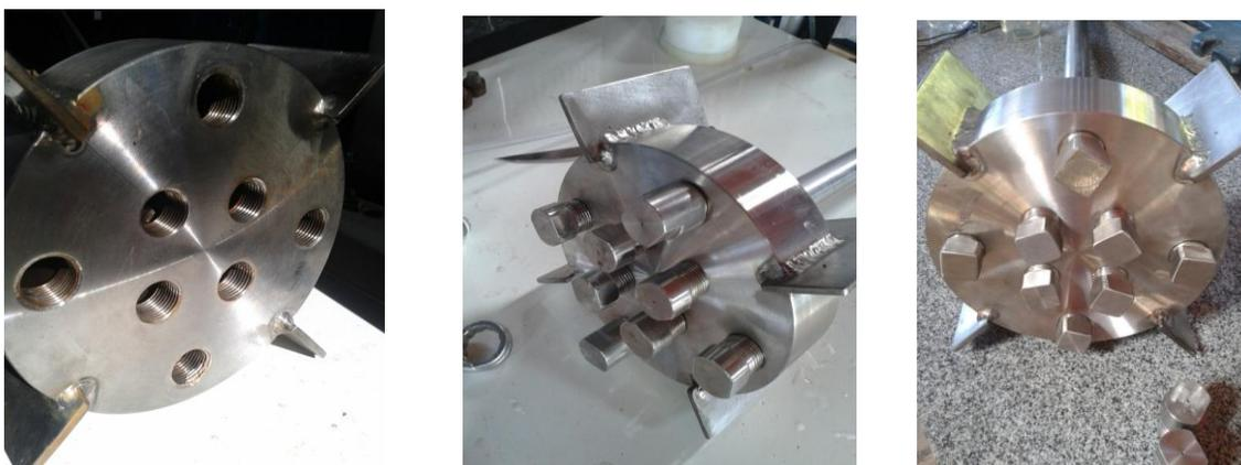
**Figura 4.16.** Suporte dos bocais novo e reforçados.
