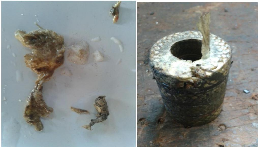
**Figura 4.14.** Particulado causador do entupimento e a gaxeta da bomba de alta pressão danificada.
