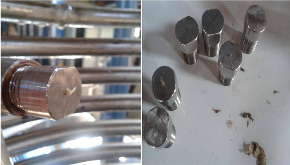
**Figura 4.13.** Bocal orifício 0,5 mm com entupimento.
