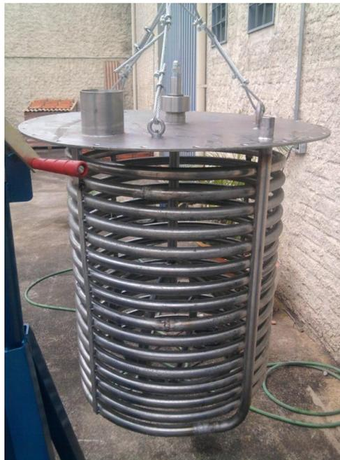
**Figura 4.9.** Fotografia da serpentina em aço inox.
