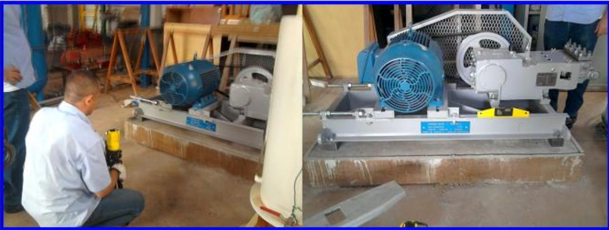
**Figura B04.** Alinhamento e posicionamento do skid da bomba de alta pressão.
