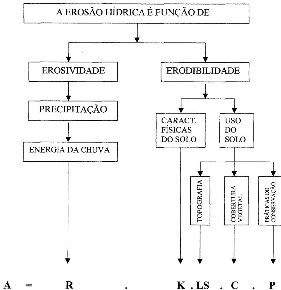
Figura 2.4 – Diagrama da Equação Universal de Perda de Solo
