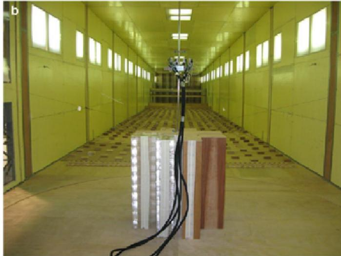
**Figura 2.46: Edificação simulada no túnel de vento**
