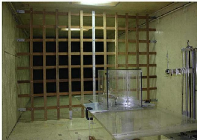
**Figura 2.38: Maquete inserida no túnel de vento**
