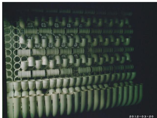
**Figura 3.2: Gerador de turbulência no túnel de vento do LACAF/Unicamp**
