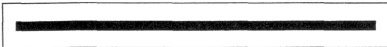
Figura 2.10: Linhas de indicação de proibição de estacionamento e/ou parada. Fonte: CTB (38).
