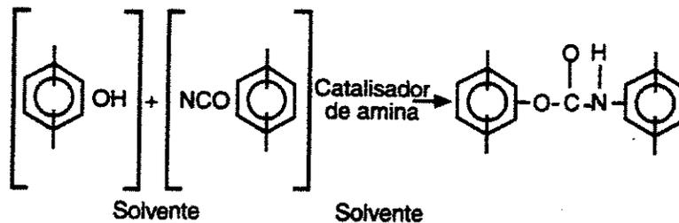
Figura 3.3 - Esquema mostrando os grupos hidroxilas fornecidos pela resina fenólica da parte I que reagem com os grupos isocianatos da parte II na presença do catalisador amina, para formar a resina uretânica sólida
