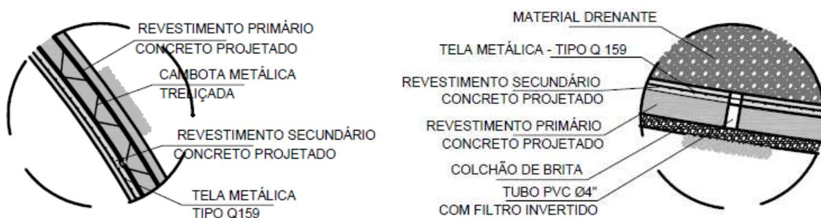
Figura 8.2 – Detalhes aplicação do concreto projetado (PETROMETAL, 2009)
