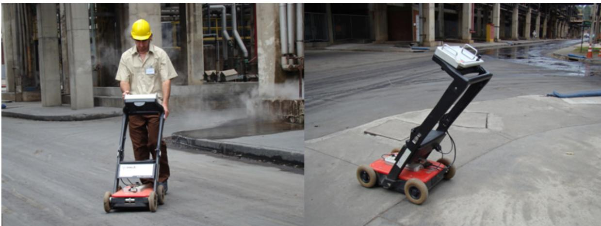
Figura 4.8 - Foto ilustrativa do equipamento GPR sendo utilizado em campo (GPR GEOSCIENCE, 2009)
