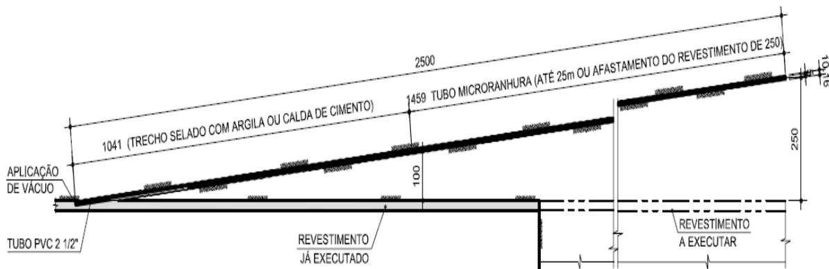
Figura 6.11 - Detalhe dreno horizontal profundo a vácuo (DHPv' s) – Túnel CAMG (PETROMETAL, 2009)
