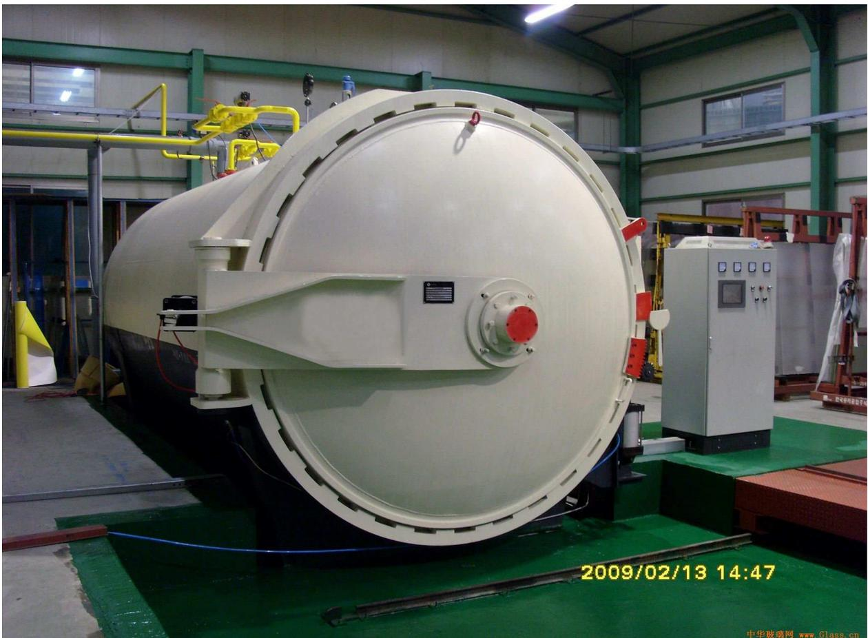
Figura 1.1 – Autoclave industrial sugerida originalmente no tratamento dos resíduos
