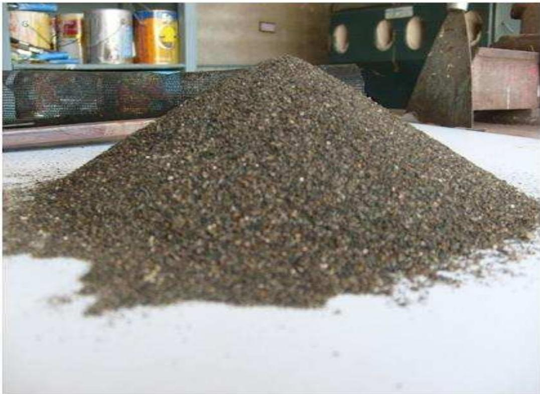
Figura 3.2 – Areia extraída do tratamento, após a referida lavagem
