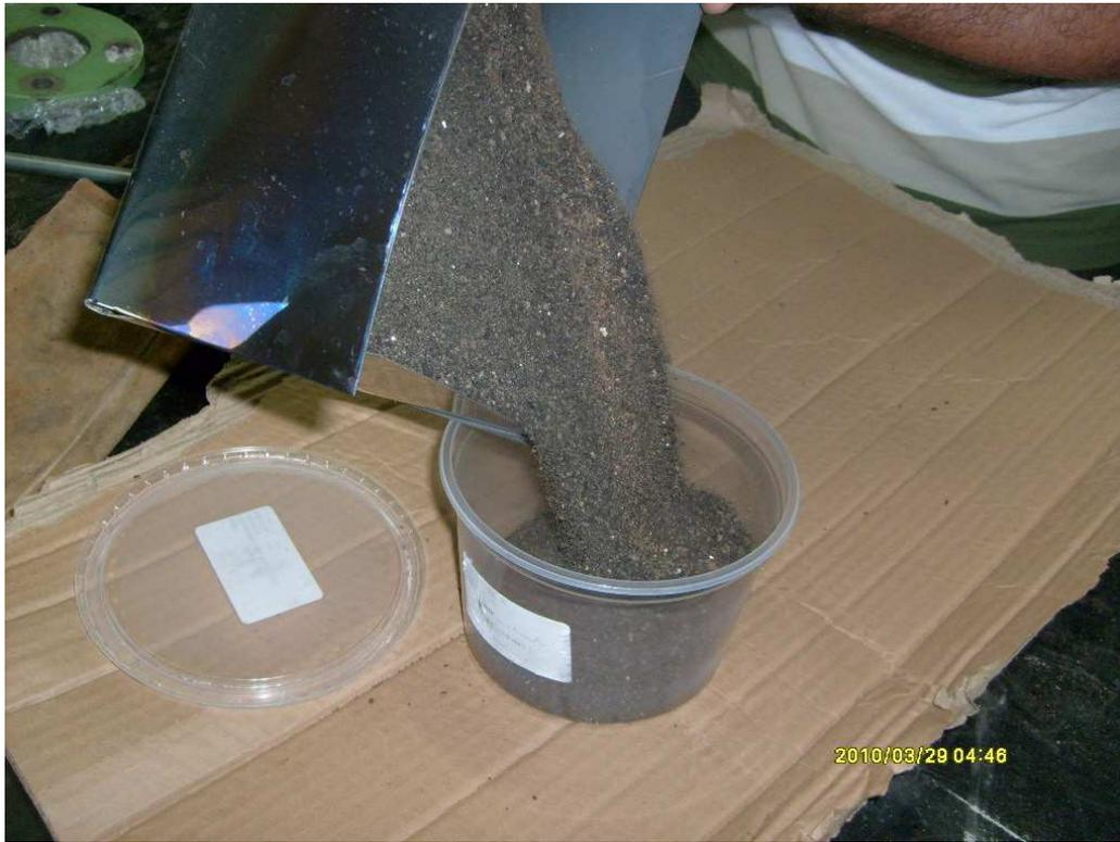
Figura 3.6 – Amostragem da areia desinfectada no protótipo de forno
