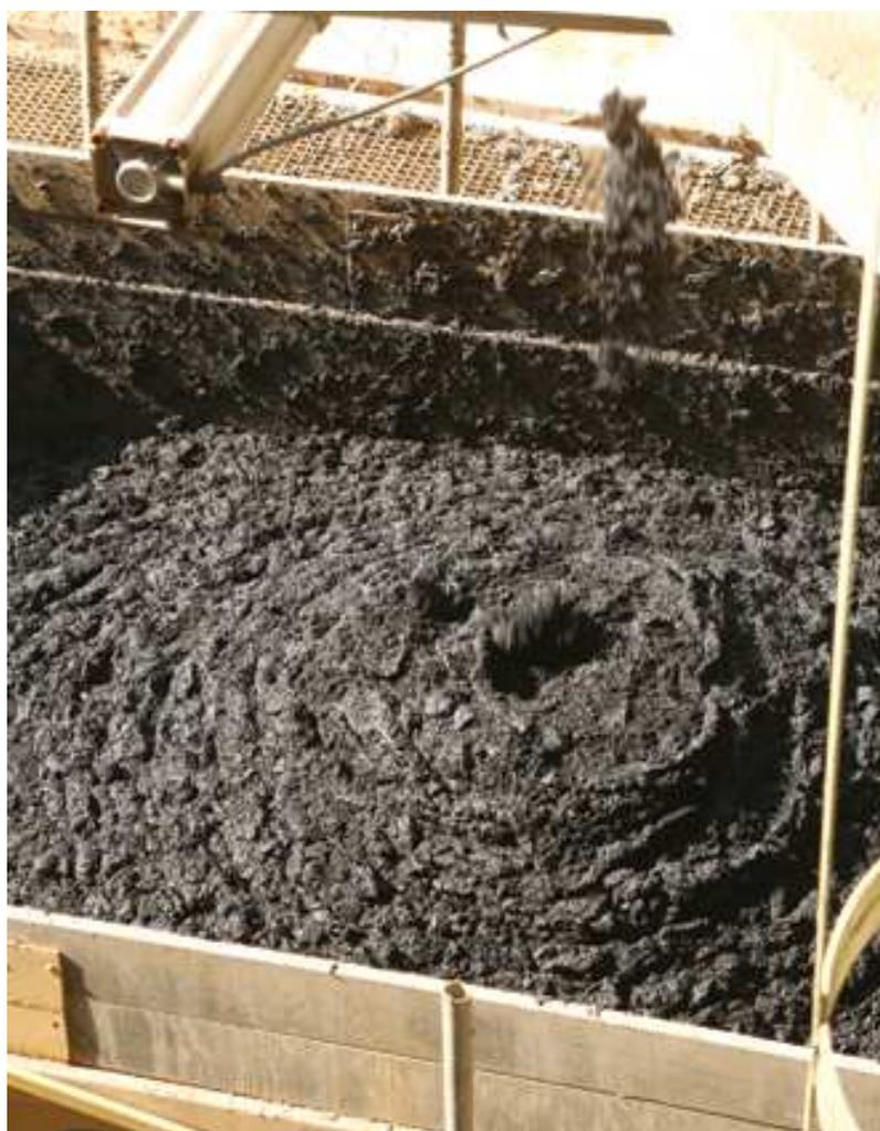
Figura 2.8 – Lodo oriundo da etapa final do tratamento de esgotos da ETE-Barueri
