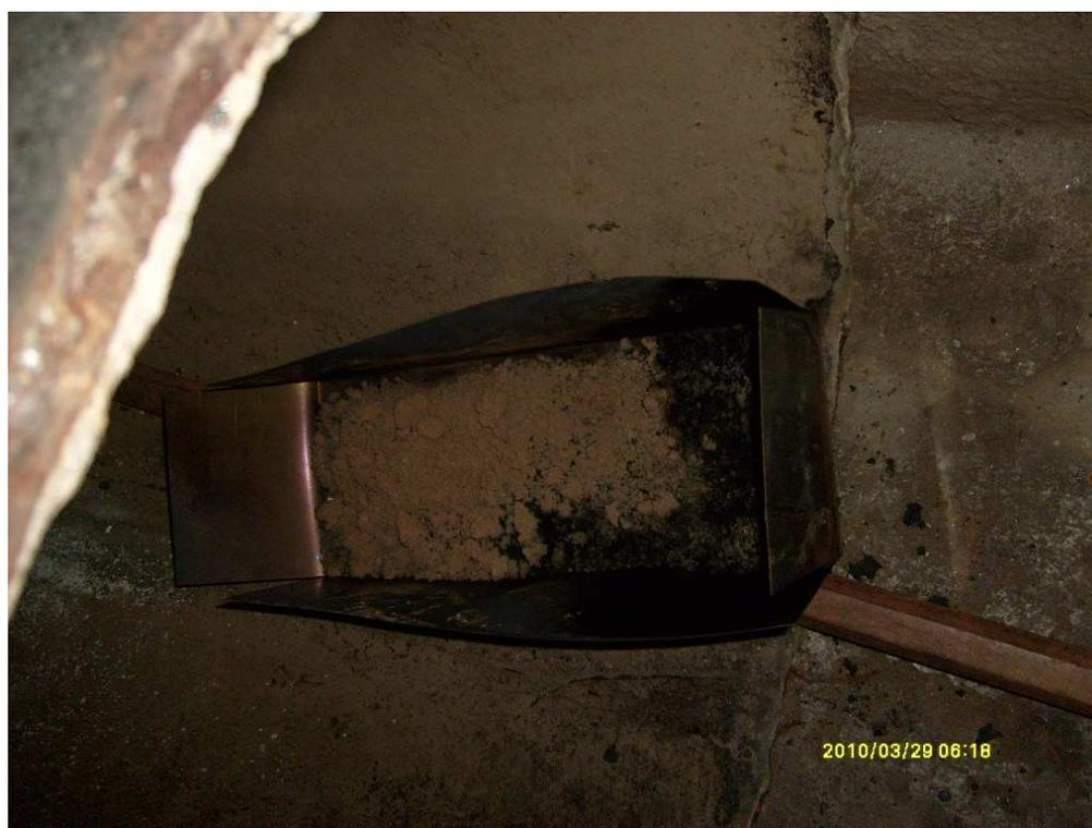
Figura 3.16 – Lodo calcinado retirado do forno industrial
