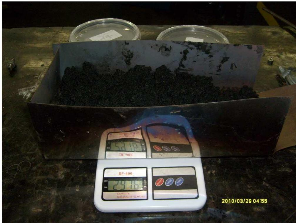
Figura 3.11 – Determinação da quantidade de amostra de lodo *in natura* a ser submetida ao forno
