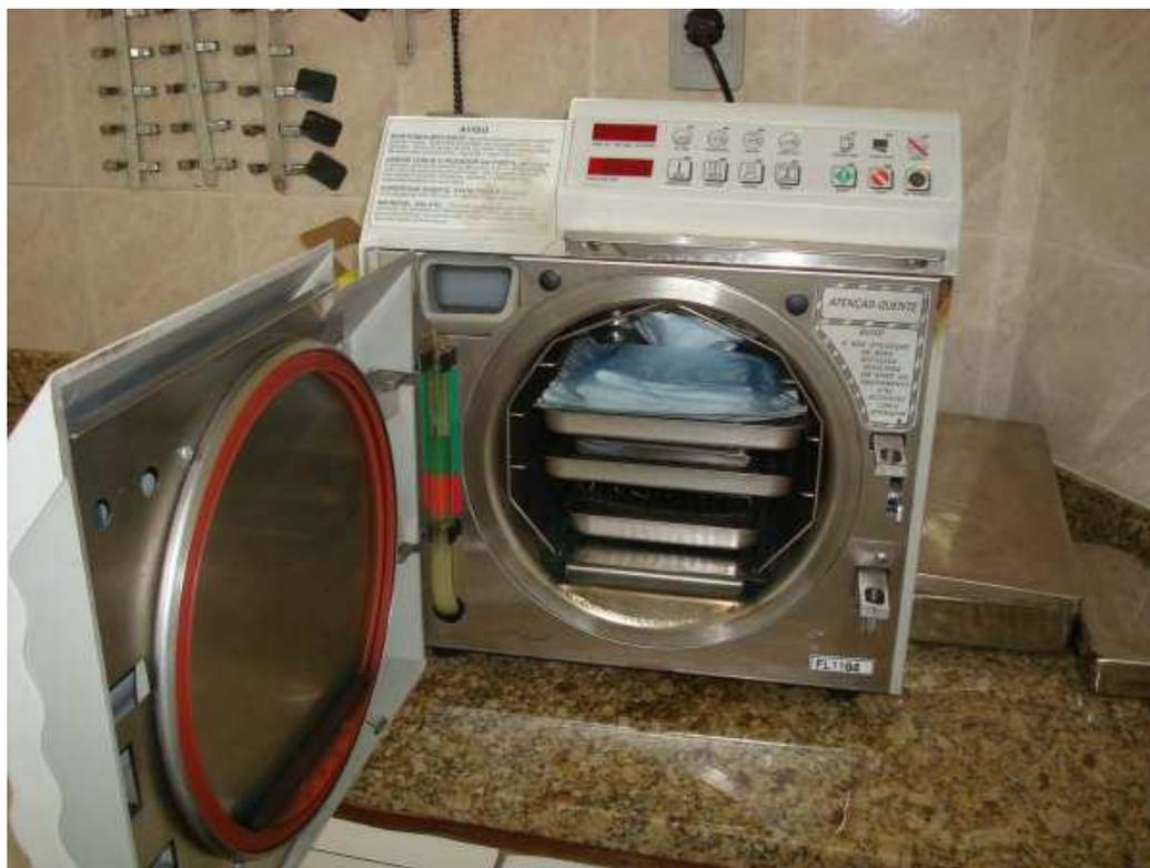
Figura 3.3 – Autoclave de laboratório utilizada no experimento
