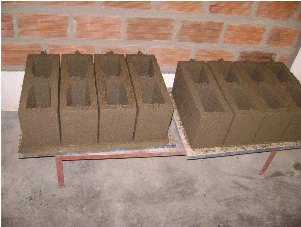
Figura 3.20 – Cura dos corpos-de-prova
