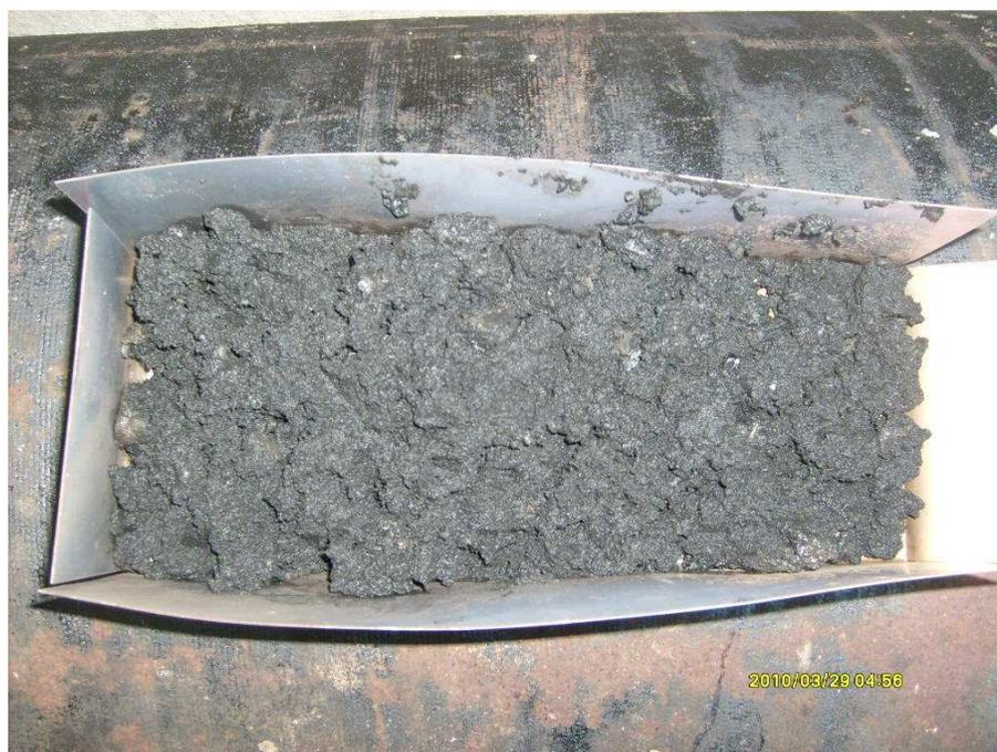
Figura 3.10 – Separação de amostra de lodo *in natura*
