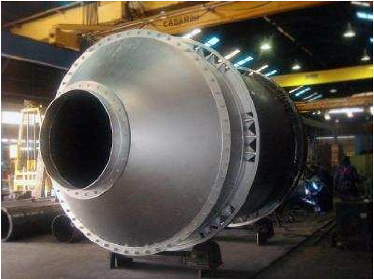
Figura 5.8 – Forno rotativo sugerido para o processo
