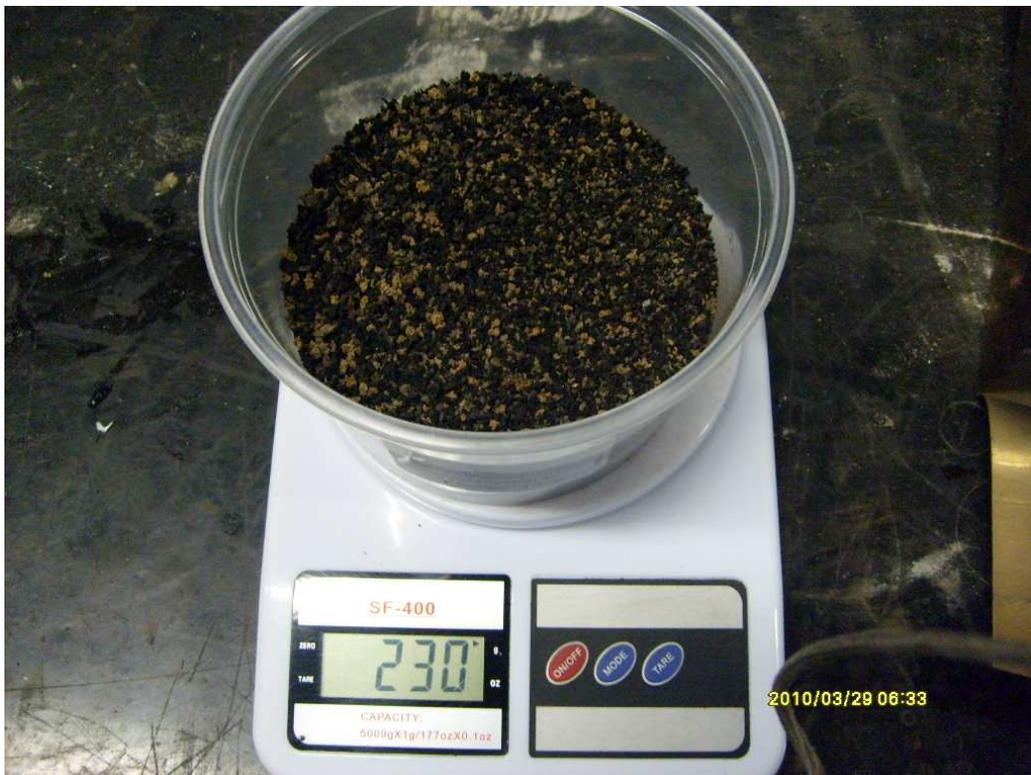
Figura 3.7 – Determinação da quantidade de areia a ser analisada
