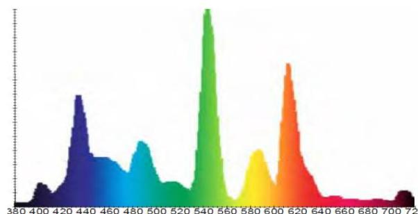
**Figura 4-67.** Distribuição Espectral de Energia #66 – 6500K - Triphosphor
