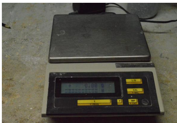
Figura 24: de absorção de água nas amostras de telha: (1) balança de precisão; (2) amostras na estufa.
