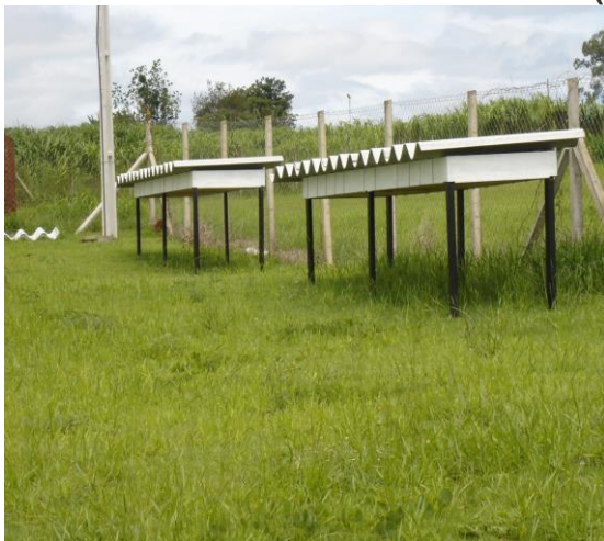
Figura 15: Experimento bancadas. (1) croqui de aquisição de dados nas bancadas; (2) duas bancadas; (3) detalhe da fixação do transdutor de calor na parte plana da telha.
