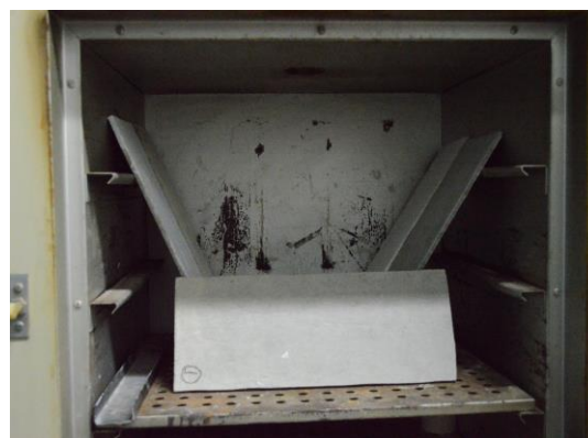
Figura 24: de absorção de água nas amostras de telha: (1) balança de precisão; (2) amostras na estufa.
