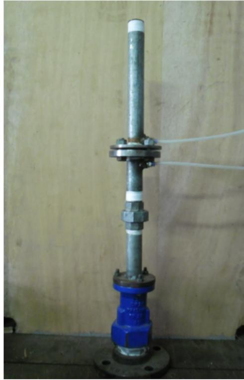
Figura 5.12 – Montagem para ensaio de expulsão da válvula Y
