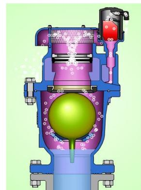
1c) Ventosa combinada – alta vazão (tríplice função)
