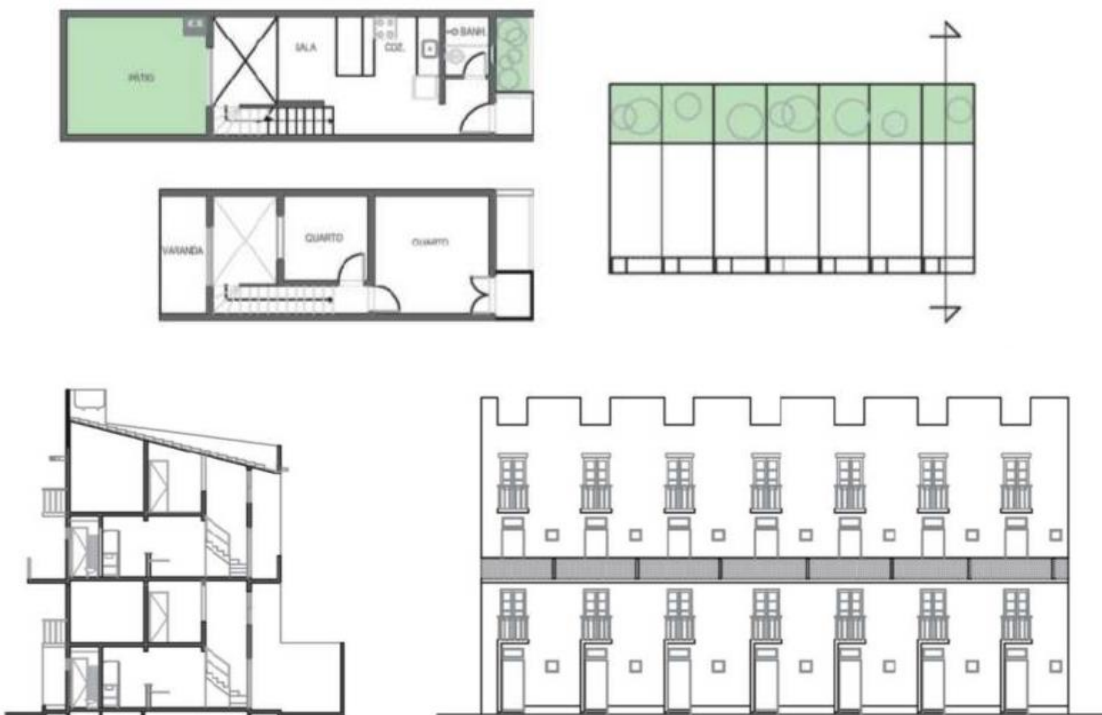
Figura 71 - Planta baixa, corte e elevação das Unidades habitacionais densificadas proposta pela equipe.
