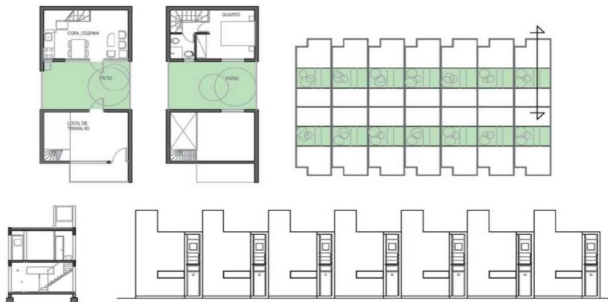
Figura 70 - Planta baixa, corte e elevação das Unidades habitacionais evolutivas propostas pela equipe.
