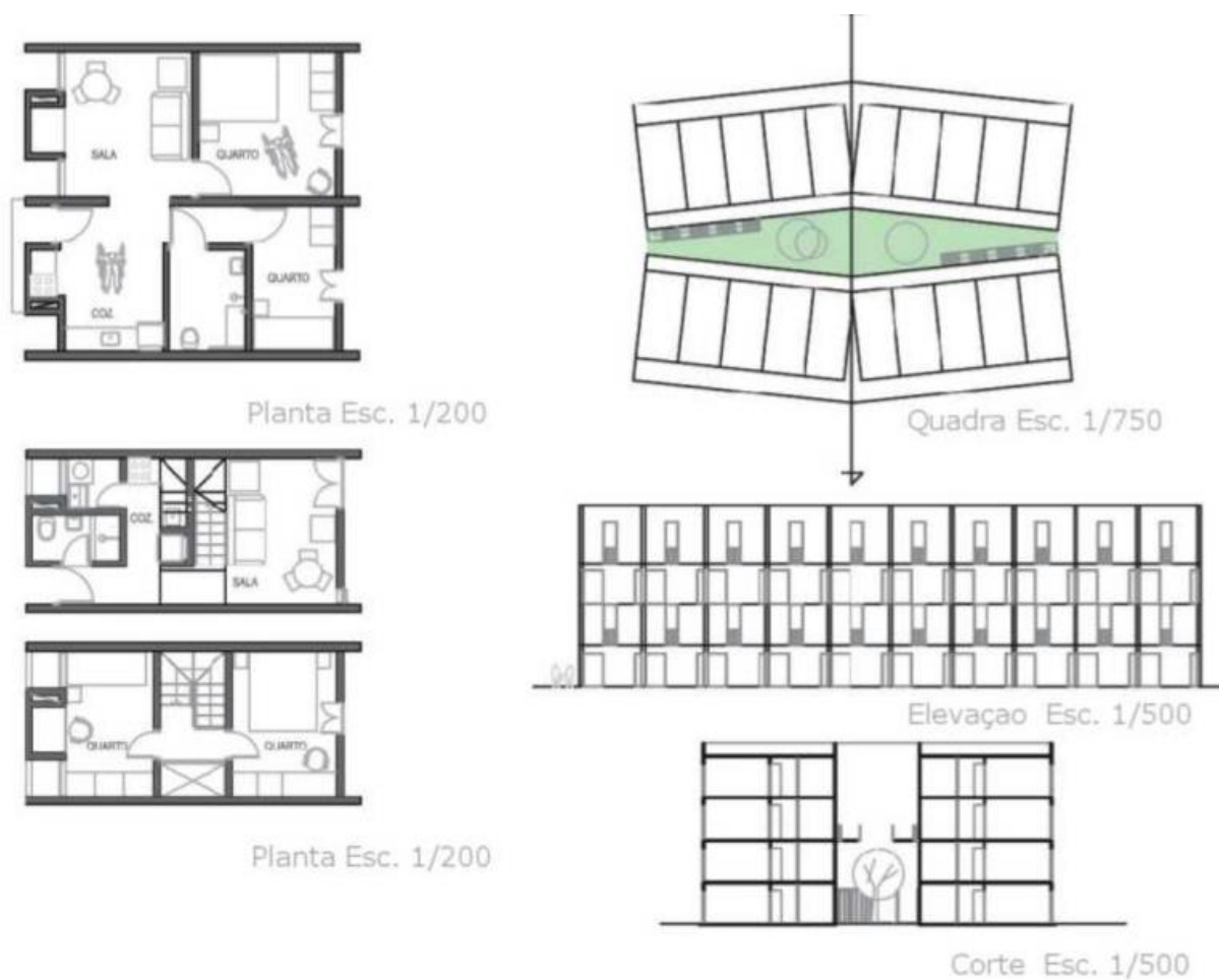
Figura 73 - Planta baixa, corte e elevação das Unidades habitacionais combinatórias propostas pela equipe.
