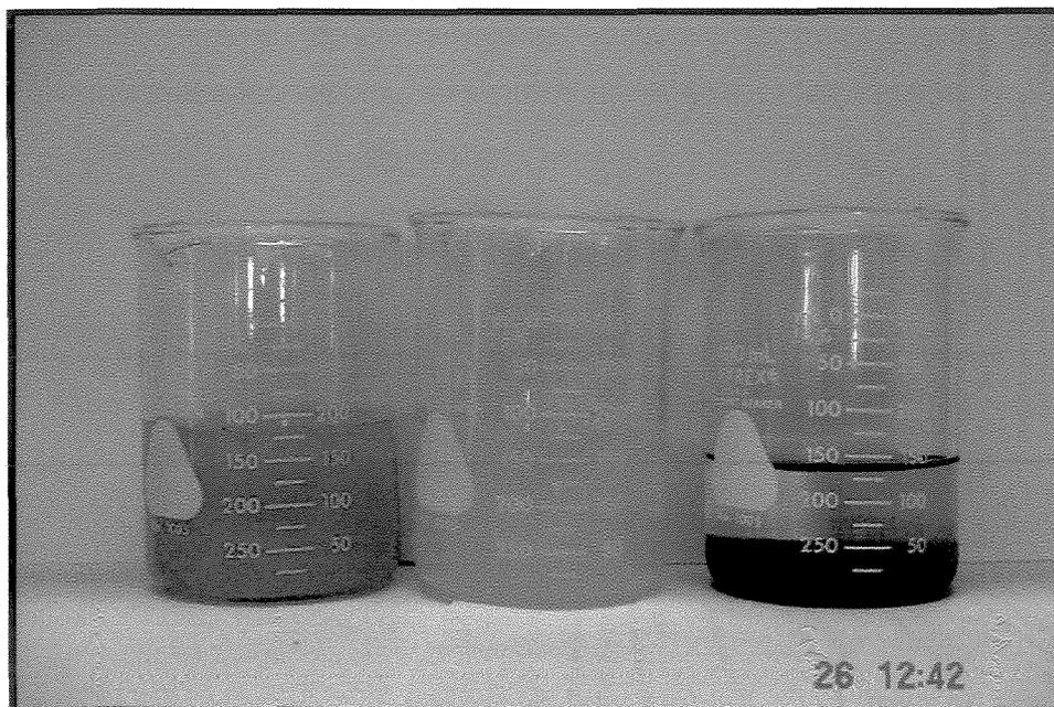
**FIGURA 8.5** – Foto dos efluentes bruto, destilado e tratado, respectivamente, da esquerda para a direita.
