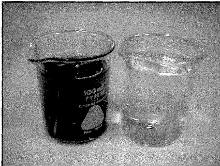
**FIGURA 8.7** – Foto da amostra bruta (esquerda) e após o tratamento fotocatalítico (direita)
