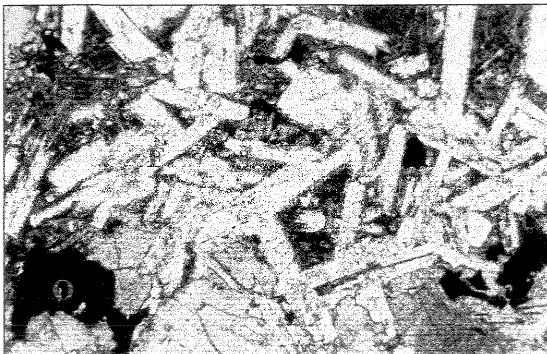
Figura 54 - Amostra 014. Notar a presença de feldspato (F), opacos (O) e vidro vulcânico (V). Aumento : 50 x.
