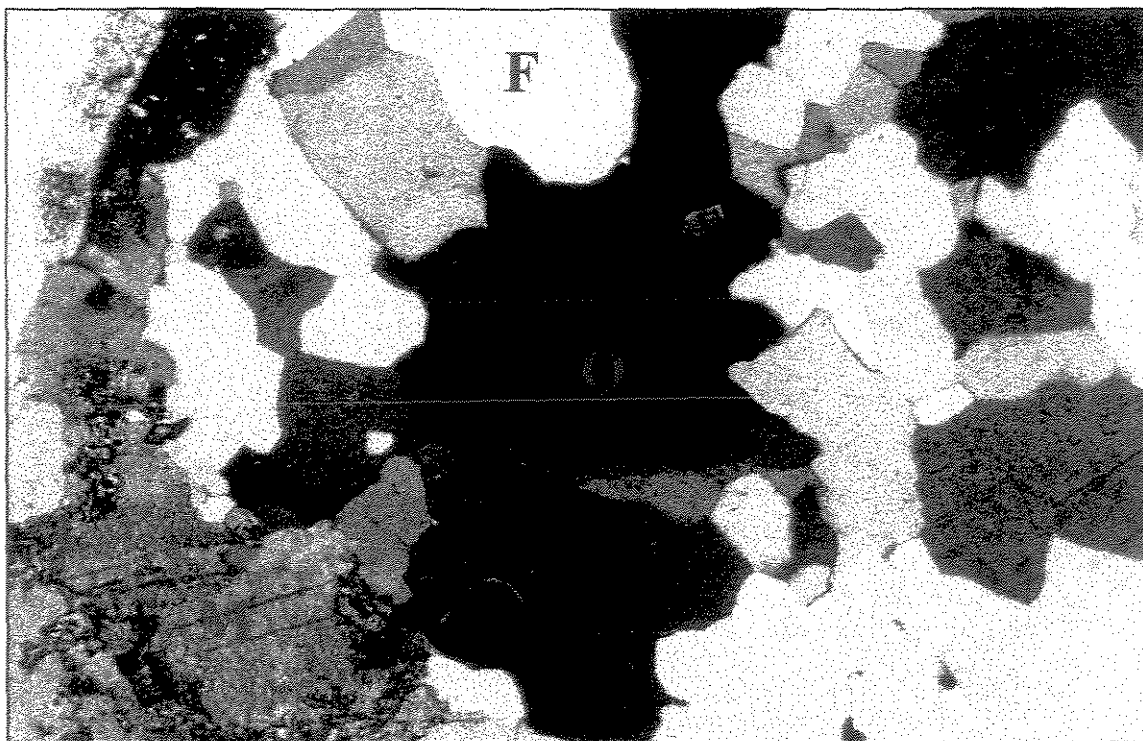
Figura 51 - Amostra 010. Notar a presença de feldspato (F), quartzo (Q) e mica (M). Aumento : 50x
