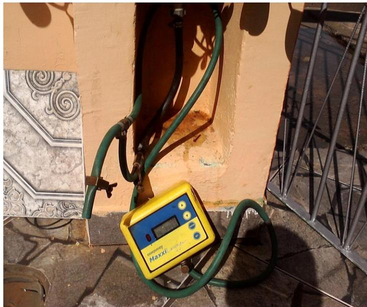
**Figura 29 - Instalação do Datalogger na Cota Média do Setor de Abastecimento (foto do autor).**
