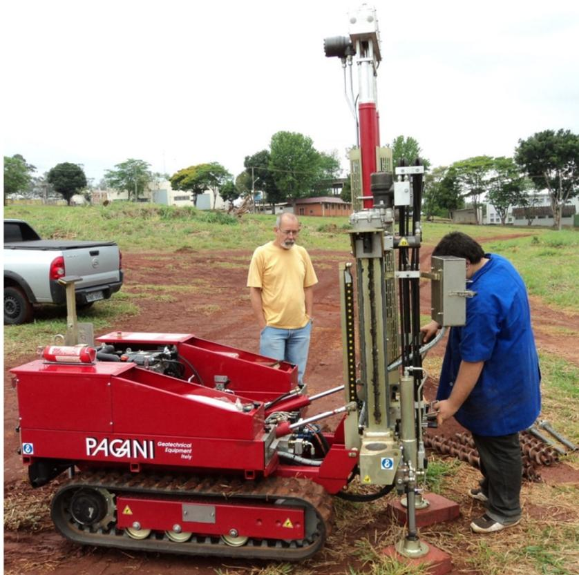
Figura 3.16: Equipamento de cravação do CPT (Pagani), com reação de 150 kN.
