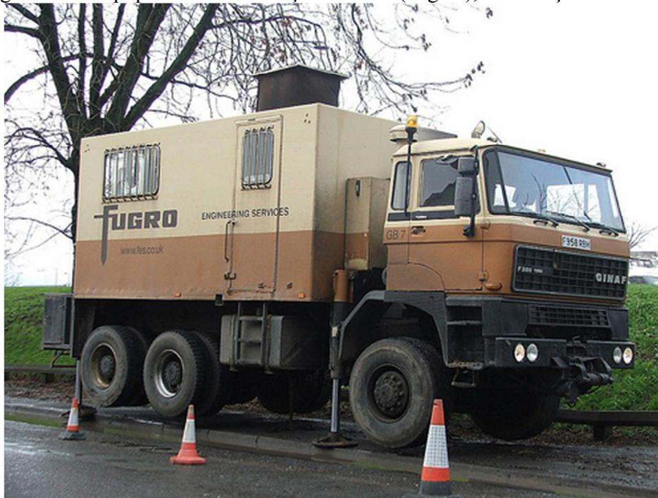
Figura 3.17: Equipamento de cravação do CPT (FUGRO), com reação de 250 kN.
