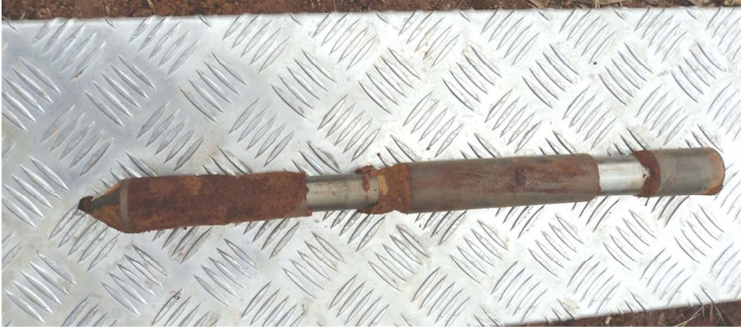
Figura 3.15: Cone de Begemann após o ensaio.
