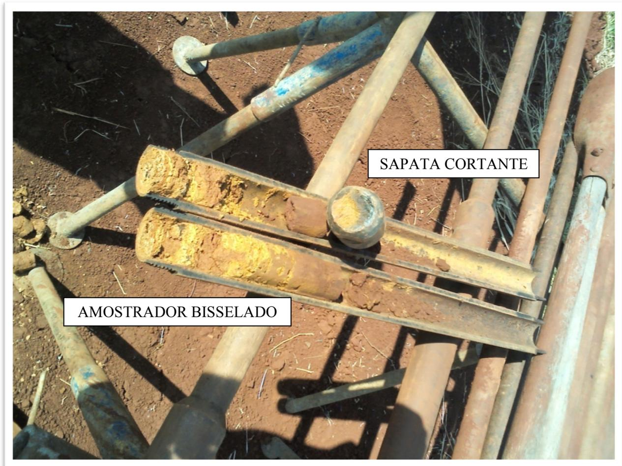
Figura 3.1: Amostrador padrão da NBR 6484/2001.
