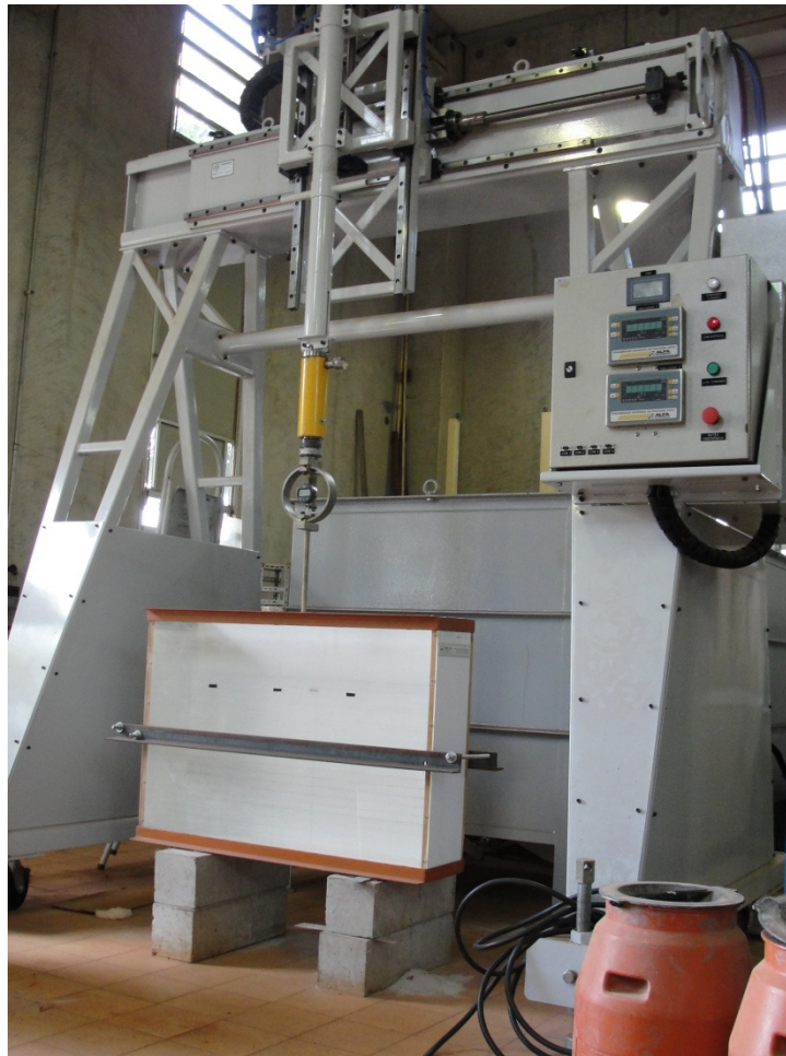
Figura 3.11 - Pórtico de aplicação de carga.
