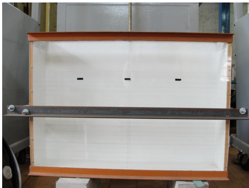
Figura 3.8 - Travamento de arestas e de faces do tanque e demarcações de camadas.
