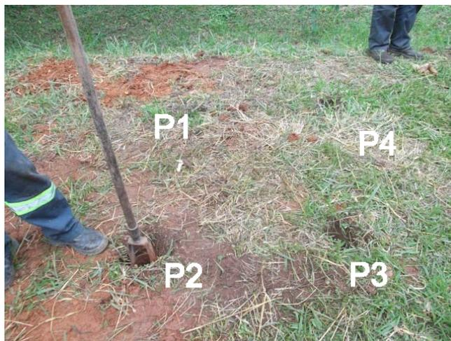
**Figura 16**-Escavação manual em torno do Amostrador
