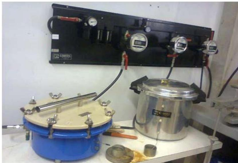
**Figura 5-**Placa de Richards de alta pressão (esquerda) e baixa pressão (direita)
