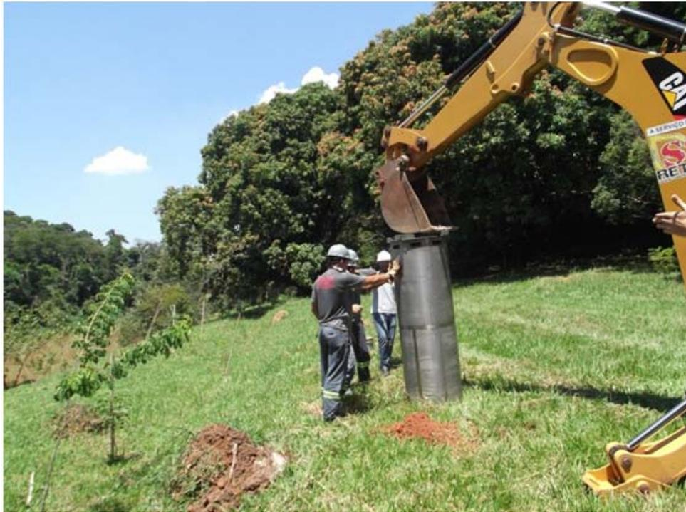
**Figura 13**-Posicionamento do Cilindro do Amostrador para Cravação no Solo
