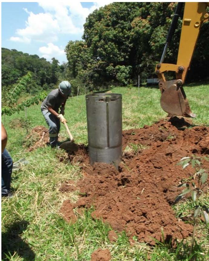
**Figura 14**-Escavação manual em torno do Amostrador
