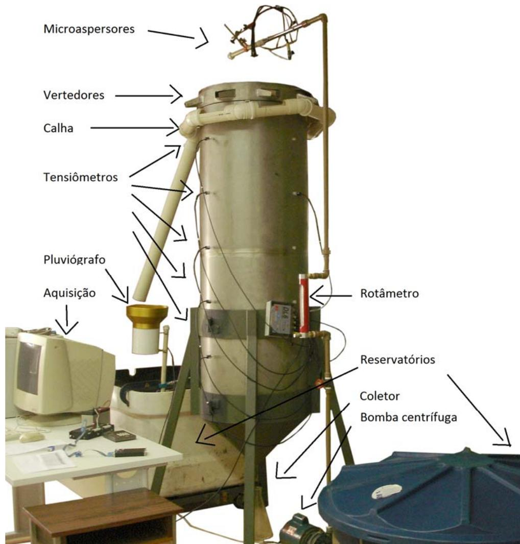
**Figura 18-**Lisímetro instalado em laboratório
