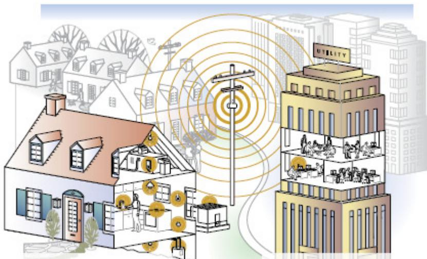
Trata-se de um projeto de medição que permitirá a utilização de sistemáticas avançadas de regulamentação de empresas de rede tais como a tarifação diferenciada. Este projeto engloba a substituição e instalação de 5 milhões de medidores de eletricidade com interfaces Zigbee em consumidores residenciais, comerciais e industriais.
