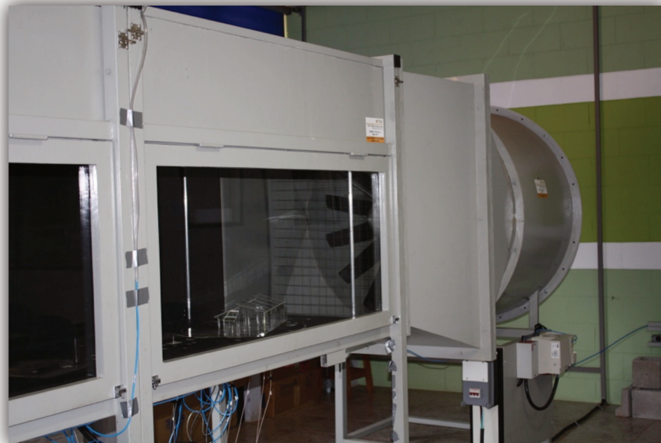
Figura 26 – Maquete fixada no túnel de vento instalado na Faculdade de Engenharia Civil, Arquitetura e Urbanismo da UNICAMP.
