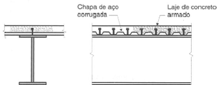
Figura 2.04 – Laje mista apoiada sobre viga metálica. Fonte: PFEIL e PFEIL (2009), p. 264.
