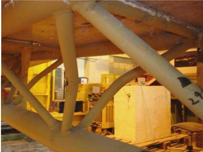
Figura 2.38 – Flambagem das diagonais comprimidas. Fonte: BRAZ (2008).
