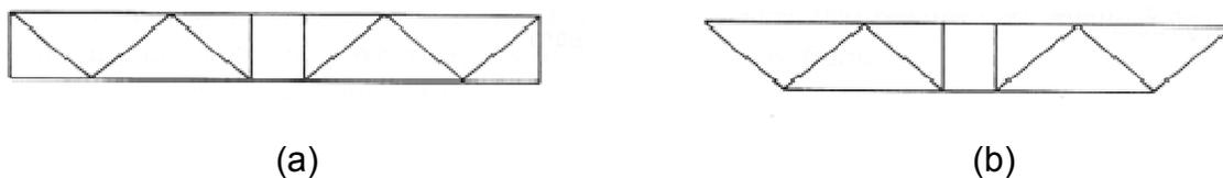
Figura 2.30 – Arranjo estrutural do banzo inferior. a) treliça Warren com painel Vierendeel central, com banzo inferior até o apoio; b) treliça Warren com painel Vierendeel central, com banzo inferior terminando no último módulo, antes do apoio. Fonte: NEAL et al. (1992), p. 06.
