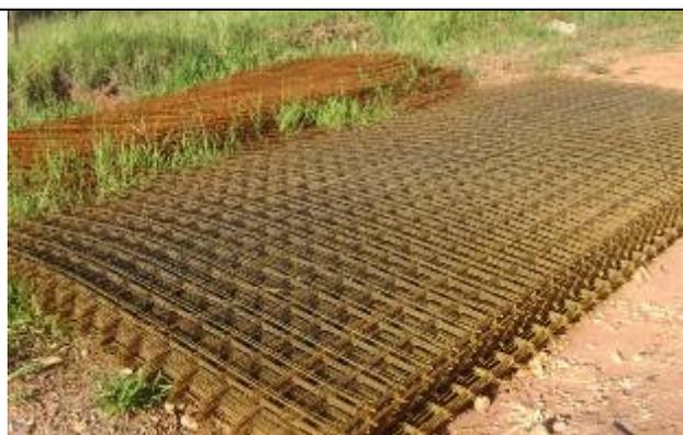
Figura 5.5 – Vista da malha utilizada como armadura.
