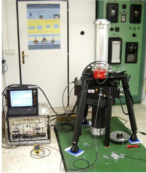
Figura 2.19: Gravímetro absoluto FG5#215
