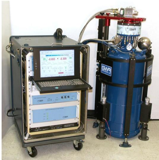
Figura 2.20: Gravímetro supercondutor OSG
