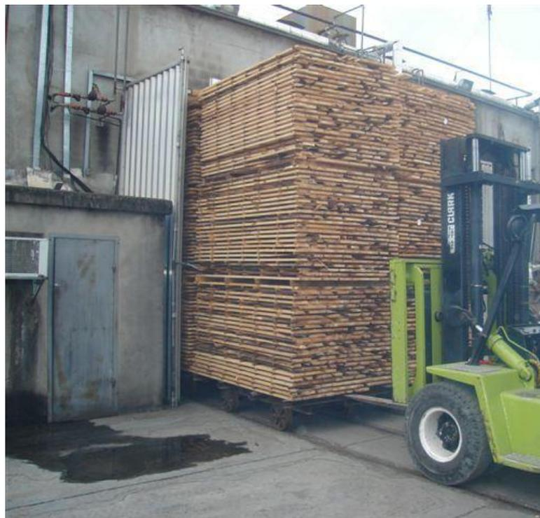
FIGURA 27a. Estufa com carregamento por empilhadeira.
