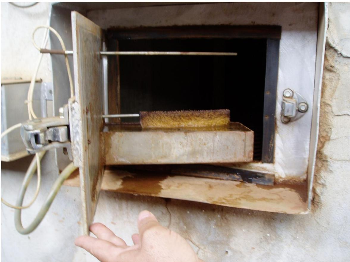
FIGURA 19 Termômetros: seco e úmido do secador convencional.
