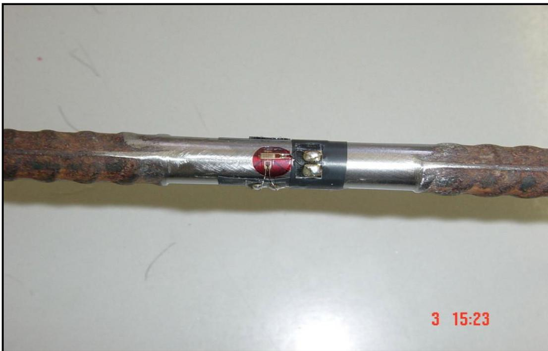
**Figura 5.4 - Filamento do Strain gages e sua fixação**
