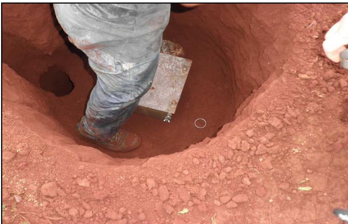
**Figura 3.2** – Retirada de amostra indeformada junto ao eixo do tubulão
