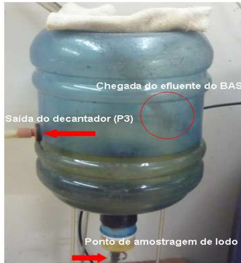
Figura 4.5: Decantador e detalhes dos locais de saída e chegada do efluente e de lodo.
