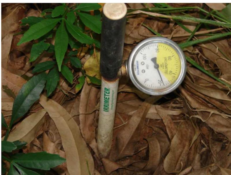
**Figura 4.10** - Tensiômetro Instalado na Área Experimental.
