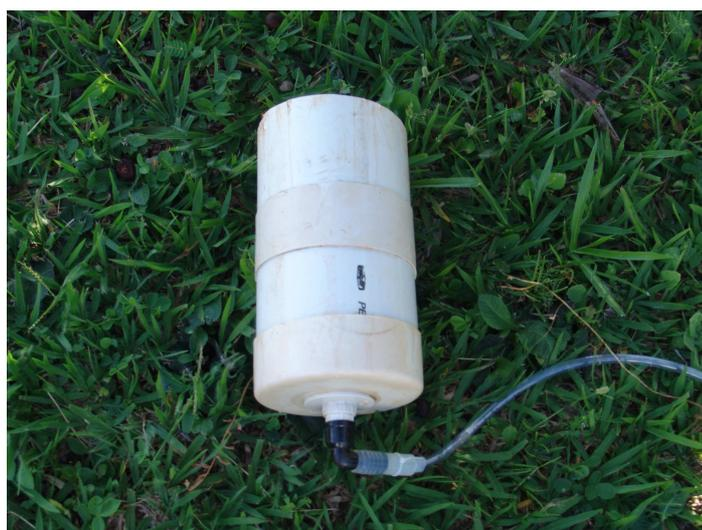
**Figura 4.12** - Modelo do coletor de drenagem livre instalado no experimento
