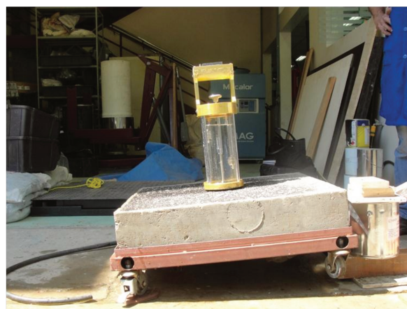
Figura 6.27 – Ensaio de drenabilidade – inclinação da placa de CBUQ de 10%.
