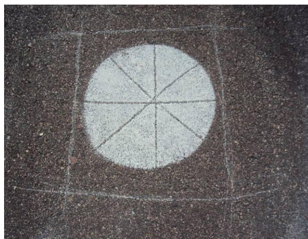
Figura 6.16 - Detalhe do ensaio da mancha de areia no Aeroporto Estadual de Bragança Paulista
