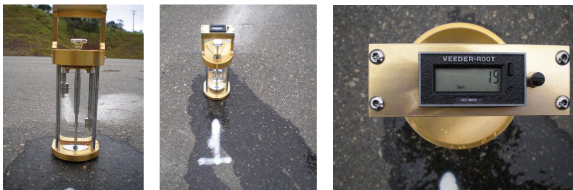
Figura 5.3 - Ensaio com o outflow meter (arquivo próprio)
