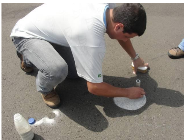
Figura 6.19 - Execução do ensaio da mancha de areia no Aeroporto Estadual de Campinas
