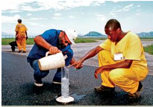
Figura 3.5 - Execução de Ensaio de Permeabilidade no Aeroporto Santos Dumont - RJ (BERNUCCI et al, 2008)
