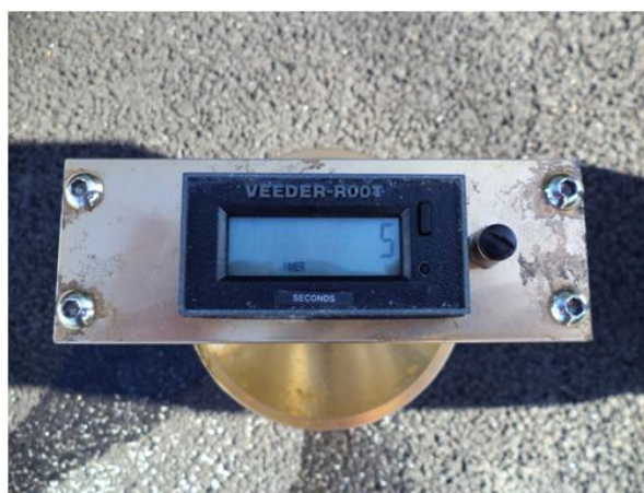
Figura 6.6 - Execução do ensaio com o outflow meter no gap-graded
