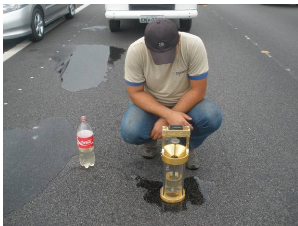
Figura 6.4 - Execução do ensaio com o outflow meter no OGFC
