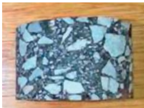
Figura 3.1 - Corpo de prova de revestimento tipo Concreto Asfáltico (BERNUCCI et al, 2008)
