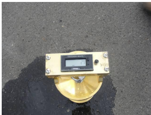
Figura 6.18 - Detalhe do cronômetro do outflow meter no Aeroporto Estadual de Campinas
