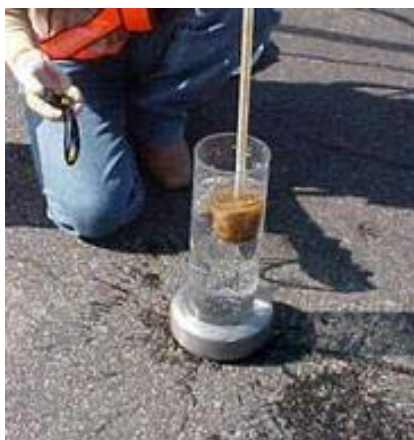
Figura 4.27 – Drenômetro LTP-USP (APS, 2006)
