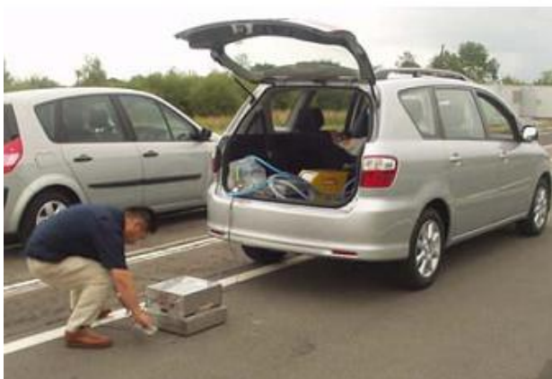
Figura 4.17 - Circular Track Meter em operação (HALL et al, 2009)
