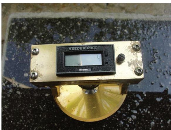
Figura 6.26 – Resultado do ensaio de drenabilidade na placa de CBUQ.
