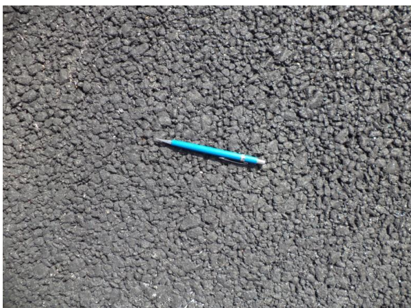
Figura 6.5 – Textura do gap-graded ensaiado
