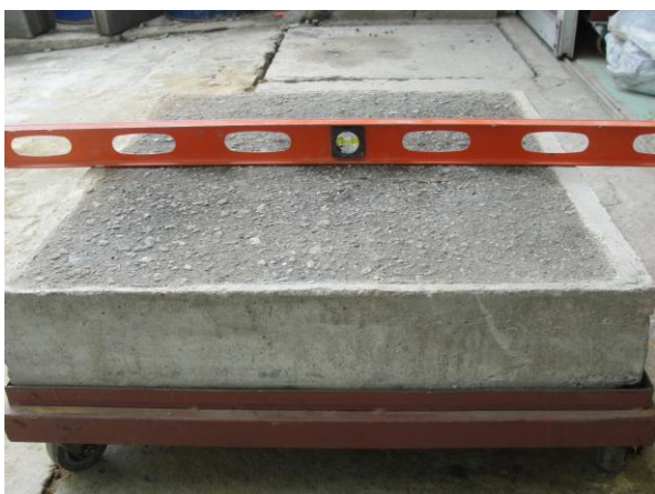
Figura 6.24 – Nivelamento da placa de CBUQ para realização do ensaio de drenabilidade.
