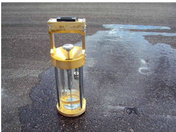
Figura 6.21 - Execução do ensaio com o outflow meter no Aeroporto Estadual de Sorocaba
