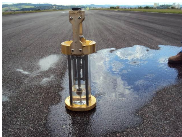
Figura 6.14 - Ensaio com o outflow meter no Aeroporto Estadual de Bragança Paulista
