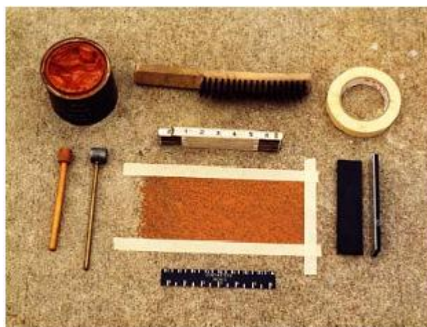
Figura 4.10 - Ensaio de Mancha de Graxa (Wambold e Henry, 2002)
