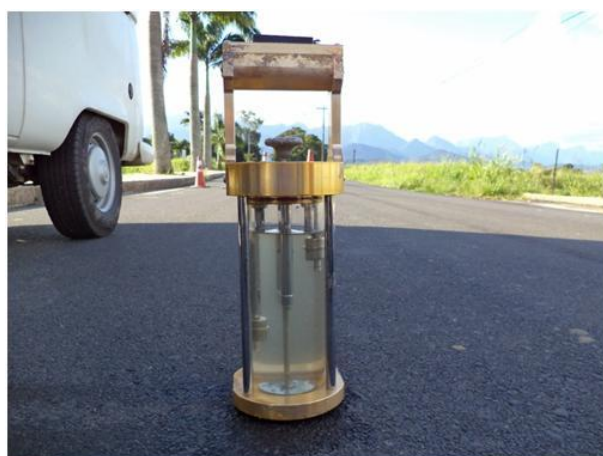
Figura 6.2 - Execução do ensaio com o outflow meter no CBUQ
