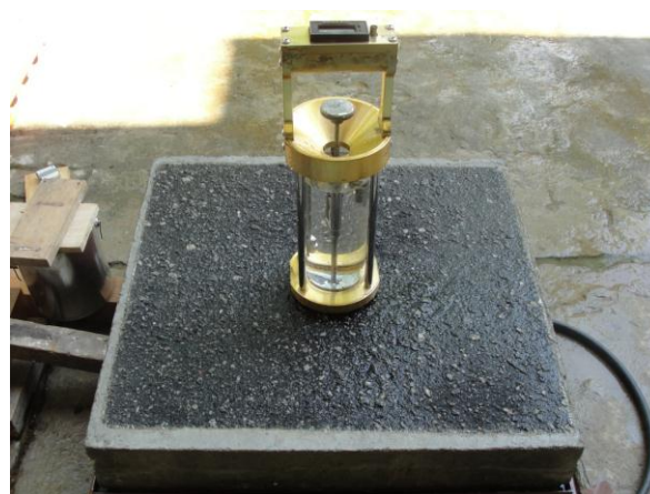
Figura 6.25 - Ensaio de drenabilidade – inclinação da placa de CBUQ de 0%
