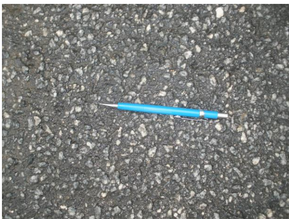
Figura 6.7 – Textura do micro revestimento asfáltico ensaiado
