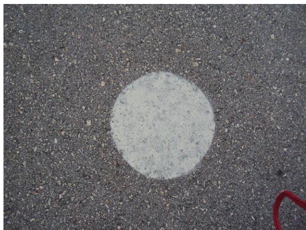
Figura 6.22 - Detalhe do ensaio da mancha de areia no Aeroporto Estadual de Sorocaba
