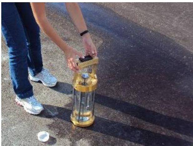
Figura 6.13 - Execução do ensaio com o outflow meter no Aeroporto Estadual de Bragança Paulista
