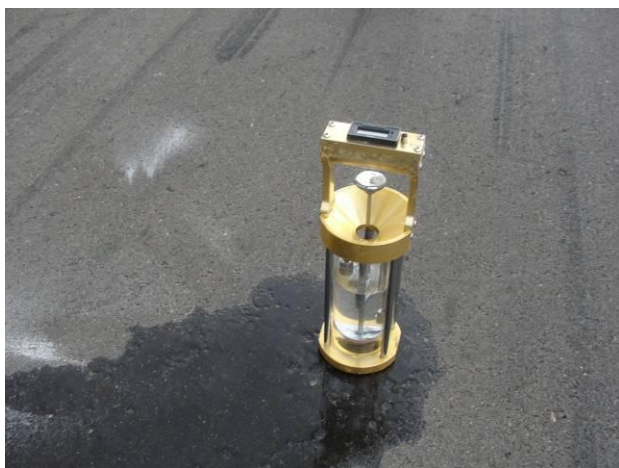
Figura 6.17 - Execução do ensaio com o outflow meter no Aeroporto Estadual de Campinas
