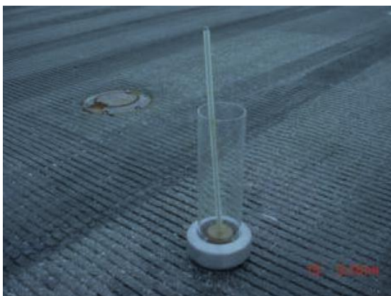
Figura 4.26 – Drenômetro no pavimento com grooving (RODRIGUES FILHO, 2006)
