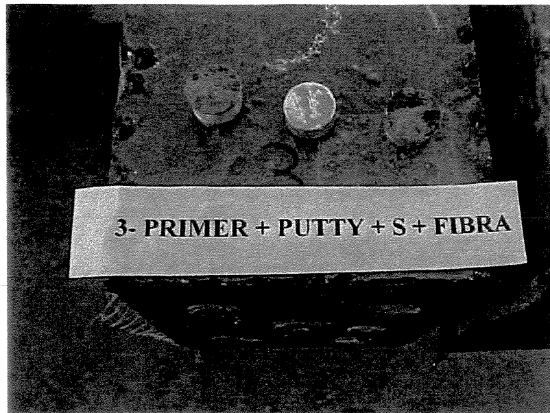
Figura 5.06 - Ensaio de aderência do Sistema 3.
