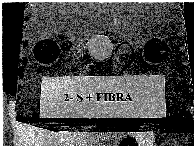
Figura 5.05 - Ensaio de aderência do Sistema 2.
