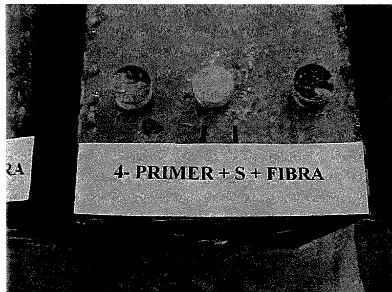
Figura 5.07 - Ensaio de aderência do Sistema 4.
