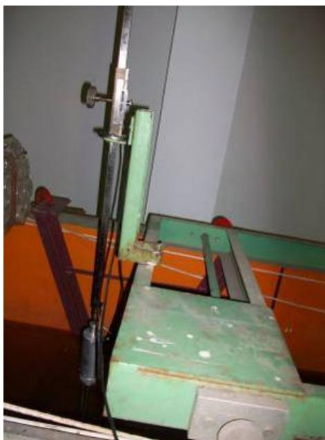
Nesse ensaio foram usadas duas pontas capacitivas: uma a barlar e a outra a sotamar do modelo, capturando a altura da onda incidente e transmitida, respectivamente.
