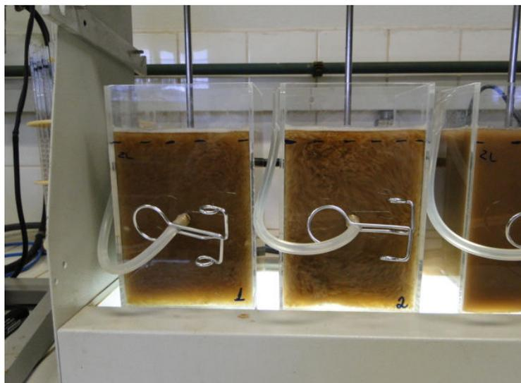
**Figura 12 Foto dos jarros após a adição de reagentes, durante a agitação**
