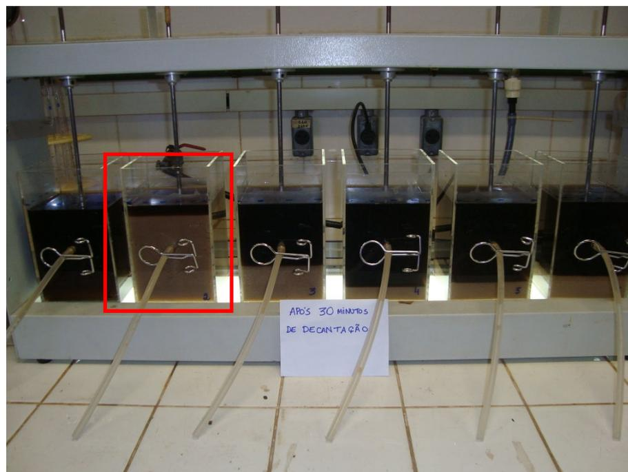
**Figura 16 Detalhe do Ensaio 8 onde houve baixa sedimentabilidade no jarro 2**
