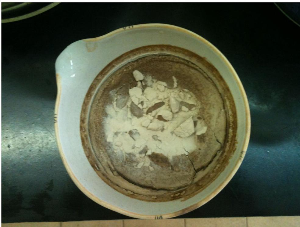
**Figura 15 Aspecto do lodo de estruvita após secagem em estufa a 60 °C**
