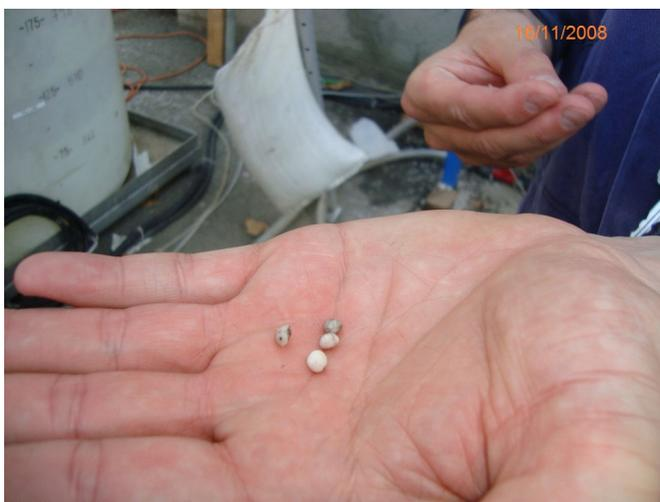
**Figura 6 Estruvita cristalizada na estação de tratamento de esgotos de São Francisco – CA.**
