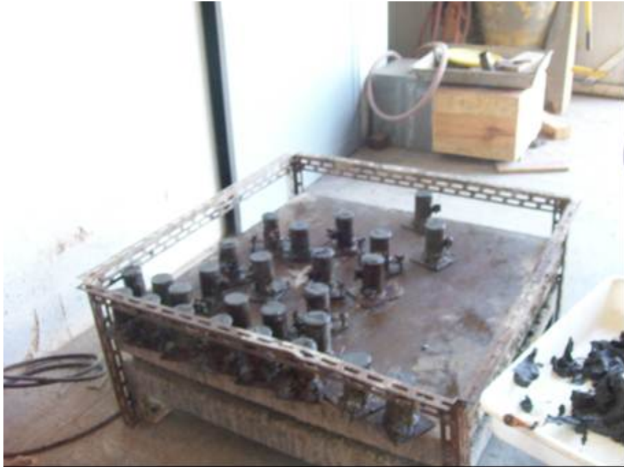
Figura 5. 1 – Densificação dos corpos-de-prova através de mesa vibratória Fonte: (arquivo pessoal)
