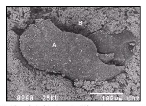
Figura 3.2 - Micrografia eletrônica de varredura de fratura de CP que mostra a aderência da pasta de cimento com a borracha sem tratamento (SEGRE-1999)
