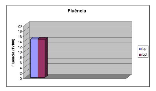
Gráfico 6.4.6 - Ensaio de fluência da mistura asfáltica, com borracha tratada e não tratada
