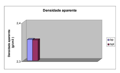
Gráfico 6.4.1 - Ensaio de densidade aparente da mistura asfáltica, com borracha tratada e não tratada
