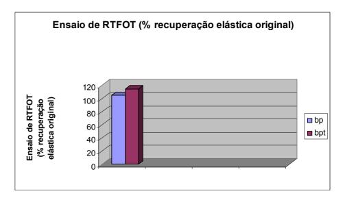
Gráfico 6.3.7.3 - Ensaio de RTFOT, quanto à % de recuperação elástica original da mistura asfáltica, com borracha tratada e não tratada
