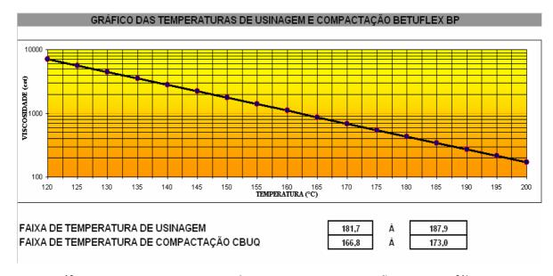
Gráfico 6.6.1 - Das temperaturas de usinagem e compactação Ligante asfáltico BP, com borracha sem tratamento
