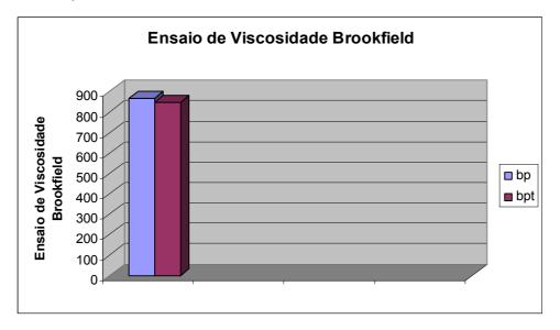
Gráfico 6.3.3 - Ensaio de Viscosidade Brookfield da mistura asfáltica, com borracha com e sem tratamento
