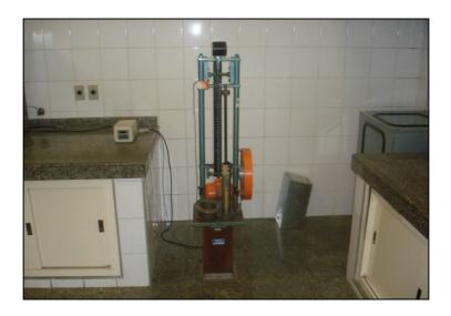
Figura 4.8.1 - Equipamento para ensaio Marshall (compactação)
