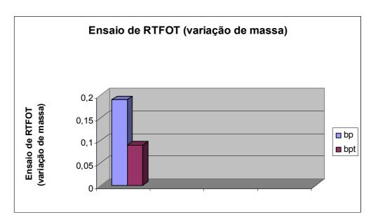
Gráfico 6.3.7.1 - Ensaio de RTFOT, quanto à perda de massa da mistura asfáltica, com borracha tratada e não tratada
