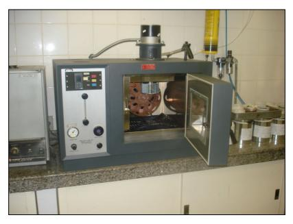
Figura 4.7.1.7 - Equipamento para determinação do efeito de calor e ar em uma película delgada rotacional (RTFOT)
