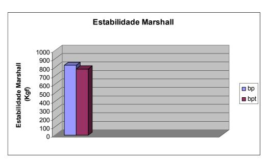
Gráfico 6.4.2 - Ensaio de estabilidade da mistura asfáltica, com borracha tratada não tratada
