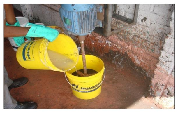
Figura 4.2.1 - Processo de tratamento com solução saturada de NaOH
