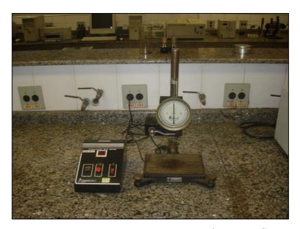
Figura 4.7.1.2 - Equipamento para ensaio de penetração
