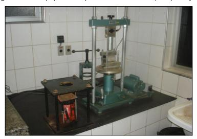
Figura 4.8.2 - Equipamento para ensaio Marshall (prensa)
