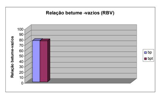
Gráfico 6.4.4 - Ensaio de relação betume-vazios da mistura asfáltica, com borracha tratada e não tratada
