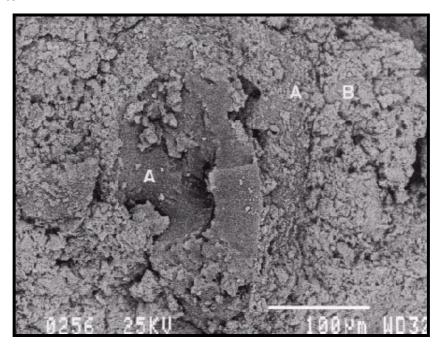
Figura 3.1 - Micrografia eletrônica de varredura de fratura de CP, que mostra a aderência da pasta de cimento com a borracha tratada com hidróxido de sódio (SEGRE-1999)
