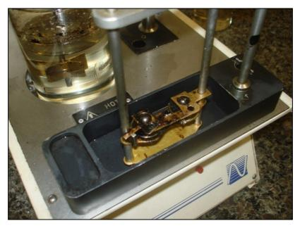
Figura 4.7.1.5 - Equipamento para ensaio de separação de fases (estabilidade a estocagem)
