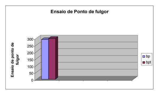
Gráfico 6.3.6 - Ensaio de Ponto de fulgor da mistura asfáltica, com borracha tratada e não tratada
