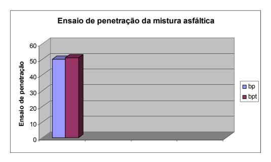
Gráfico 6.3.2 - Ensaio de penetração da mistura asfáltica, com borracha com e sem tratamento
