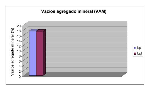
Gráfico 6.4.5 - Ensaio de vazios agregado mineral da mistura asfáltica, com borracha tratada e não tratada
