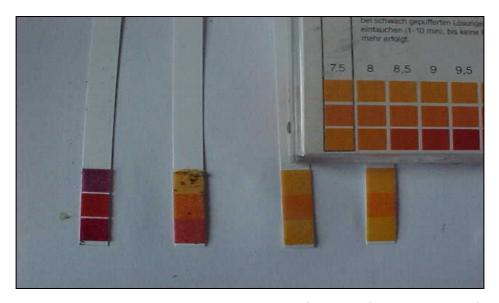
Figura 4.2.3 - Papel indicador de pH em contato com a água do pó de borracha após lavagem
