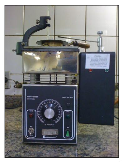
Figura 4.7.1.6 - Equipamento para determinação dos pontos de fulgor e de combustão em vaso aberto Cleveland
