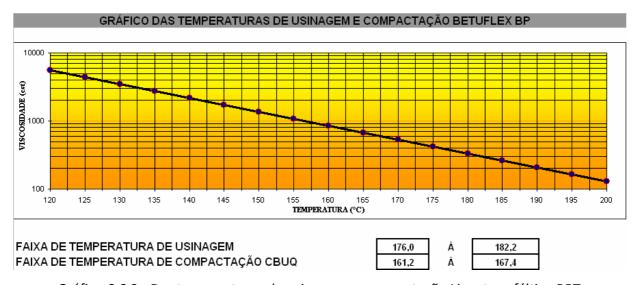
Gráfico 6.6.2 - Das temperaturas de usinagem e compactação Ligante asfáltico BPT com borracha tratada
