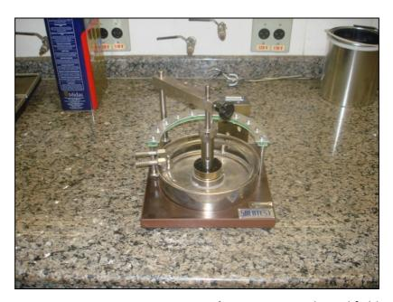
Figura 4.7.1.3 - Equipamento viscosímetro rotacional Brookfield
