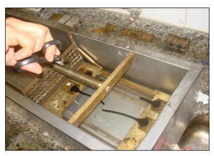
Figura 4.7.1.4 - Ensaio de recuperação elástica Ductilomêtro
