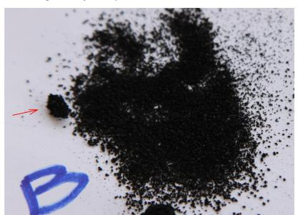
Figura 6.1 - Desaglomeração do pó de borracha tratado com hidróxido de sódio
