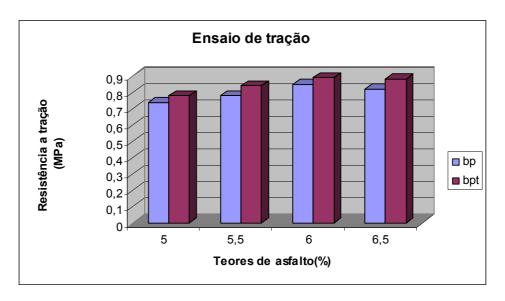
Gráfico 6.5 - Ensaio de tração das misturas asfálticas, com borracha tratada e não tratada
