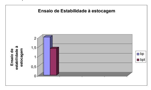
Gráfico 6.3.5 - Ensaio de Estabilidade à estocagem da mistura asfáltica, com borracha tratada e não tratada
