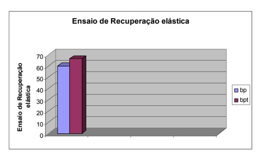
Gráfico 6.3.4 - Ensaio de Recuperação elástica da mistura asfáltica, com borracha tratada e não tratada
