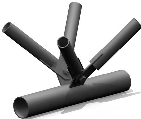
Figura 1.1 – Ligação diagonal-banzo com chapa de topo de uma treliça espacial
