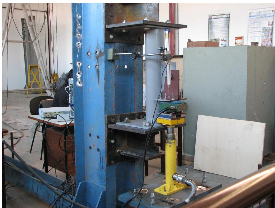
Figura 3.3 – Posicionamento dos protótipos de ensaio no pórtico e sistema de aplicação de forças
