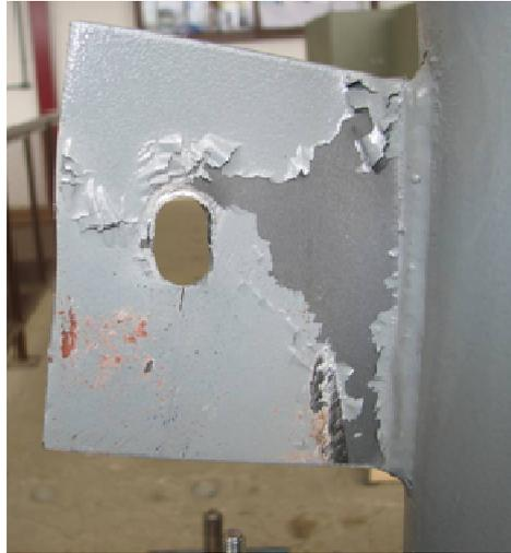
Figura 4.17 – Deformada do modelo experimental
