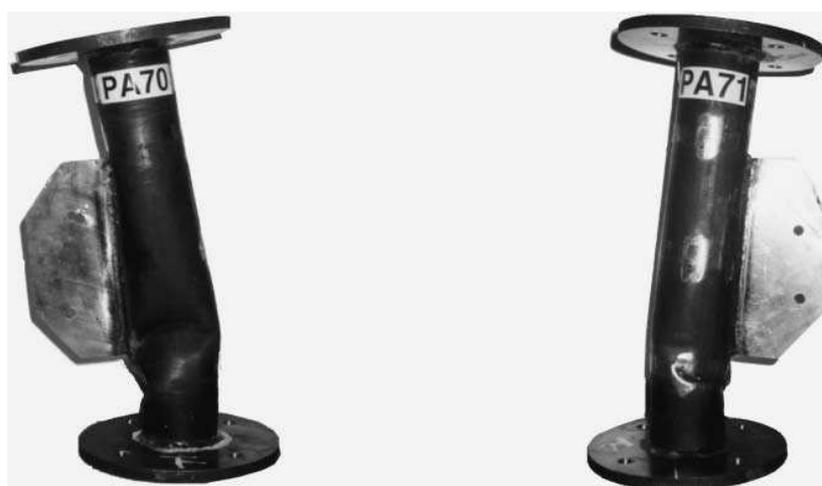
Figura 1.14 – Modo de colapso das ligações tubo-chapa de topo. KIM (2001)
